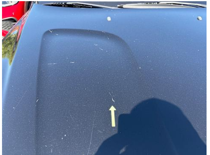
Motorhaube (Rost, Kratzer)
