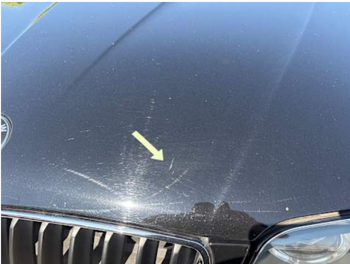
Motorhaube (Rost, Kratzer)
