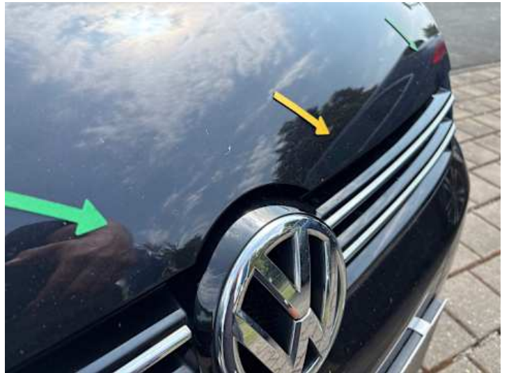
Motorhaube (Kratzer, Rost, Verformung)
