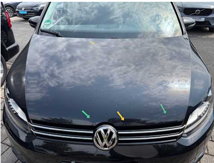
Motorhaube (Kratzer, Rost, Verformung)
