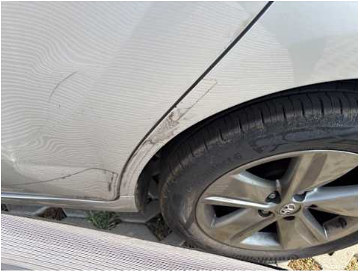
Seitenteil hinten links (Verformung, Kratzer)
