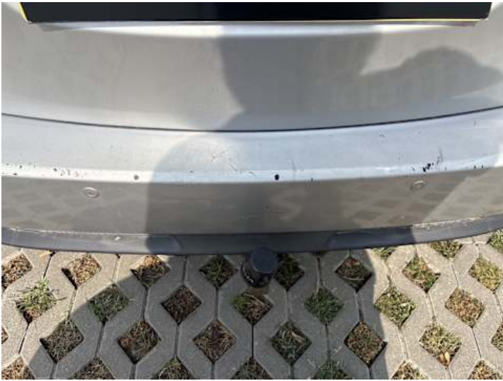
Stoßstange hinten (Spaltmaße ungenau, Kratzer, Riss/Bruch, Verformung)
