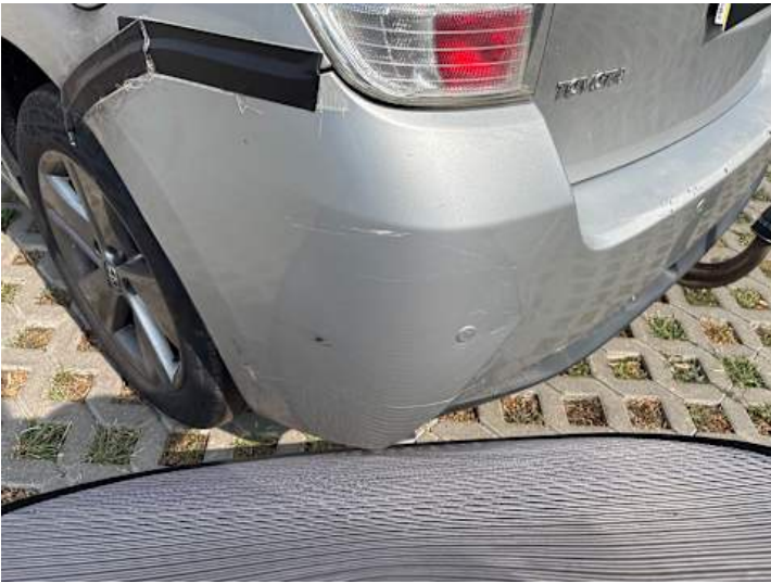
Stoßstange hinten (Spaltmaße ungenau, Kratzer, Riss/Bruch, Verformung)
