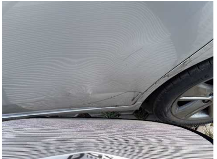
Türe hinten links (Kratzer, Verformung)
