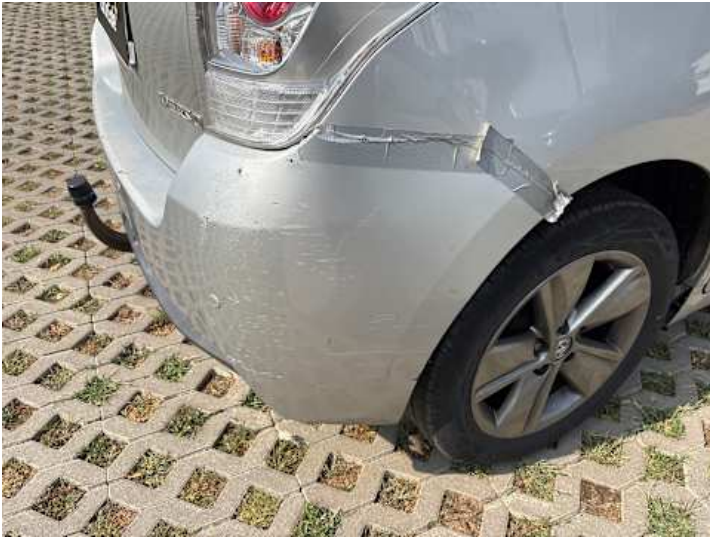
Stoßstange hinten (Spaltmaße ungenau, Kratzer, Riss/Bruch, Verformung)
