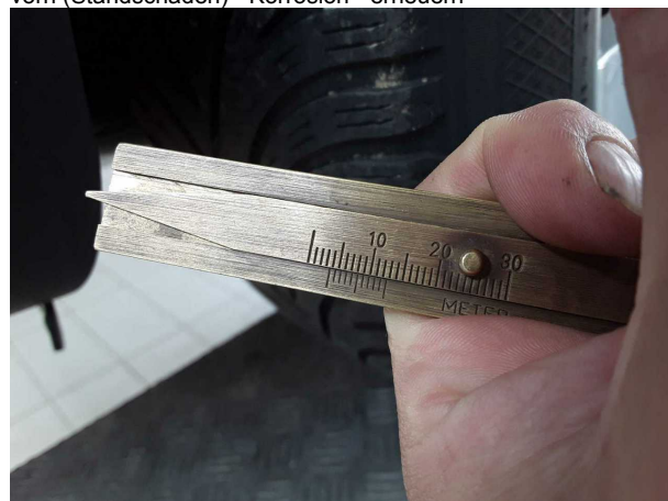
Beschädigung #6: Rad/Reifen: Reifensatz komplett - verschlissen - erneuern
