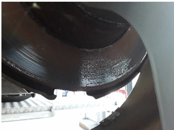
Beschädigung #4: Bremsanlage: Bremsscheiben und Beläge hinten (Standsschaden) - Korrosion - erneuern
