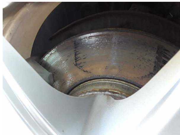
Beschädigung #5: Bremsanlage: Bremsscheiben und Beläge vorn (Standsschaden) - Korrosion - erneuern
