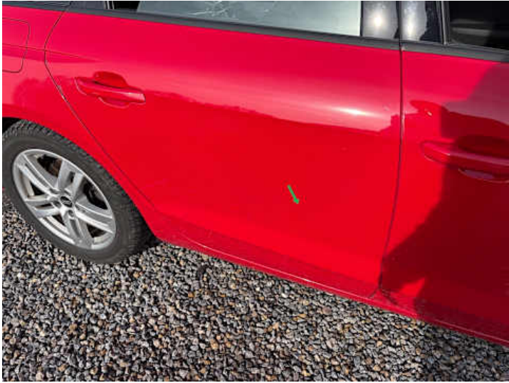
Türe hinten rechts (Delle)
