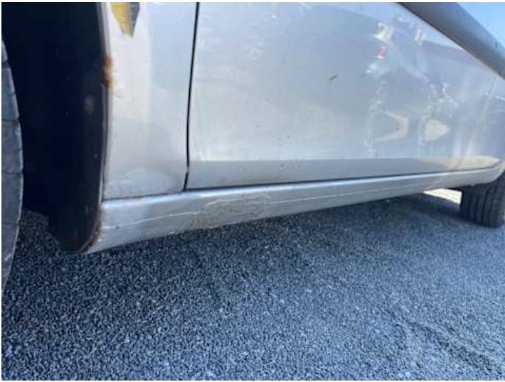
Schweller links (Rost)
