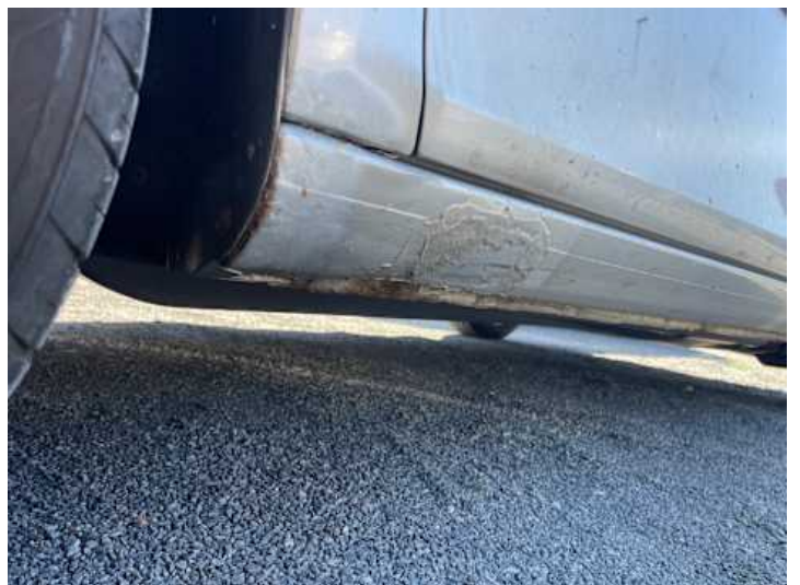
Schweller links (Rost)
