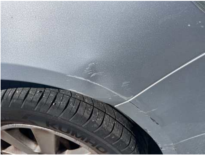
Kotflügel vorne rechts (Delle, Kratzer)
