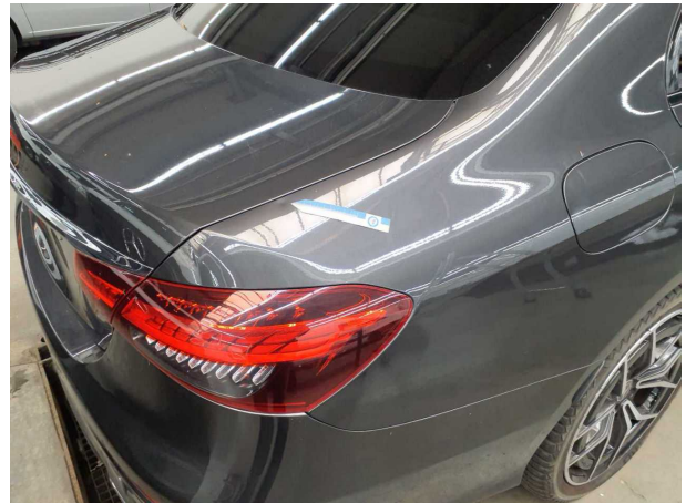
Beschädigung #2: Seitenwand rechts: Seitenwand - Delle(n) - Smart Repair
