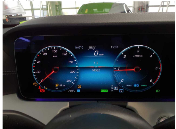
Beschädigung #3: Instrumententafel: Kontrollleuchte (Motorkontrollleuchte - Kostenausweitung möglich) - Befund
