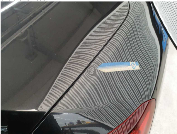
Beschädigung #2: Seitenwand rechts: Seitenwand - Delle(n) - Smart Repair
