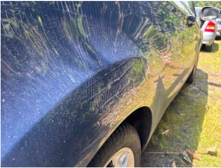
Seitenteil hinten rechts (Verformung)
