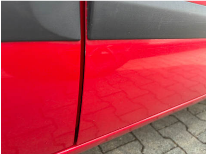
Beifahrtür (Lackschaden, Kratzer)
