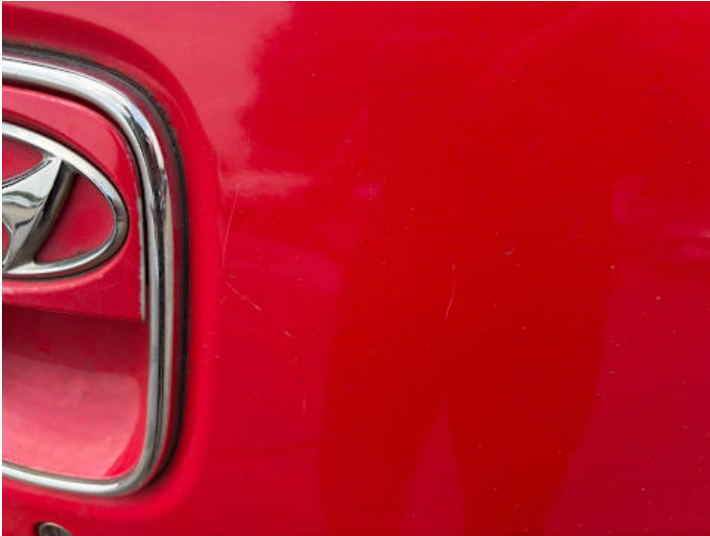
Heckklappe (Lackschaden, Kratzer)
