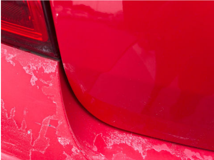
Heckklappe (Lackschaden, Kratzer)
