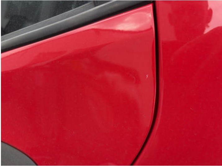
Türe hinten links (Lackschaden, Kratzer)
