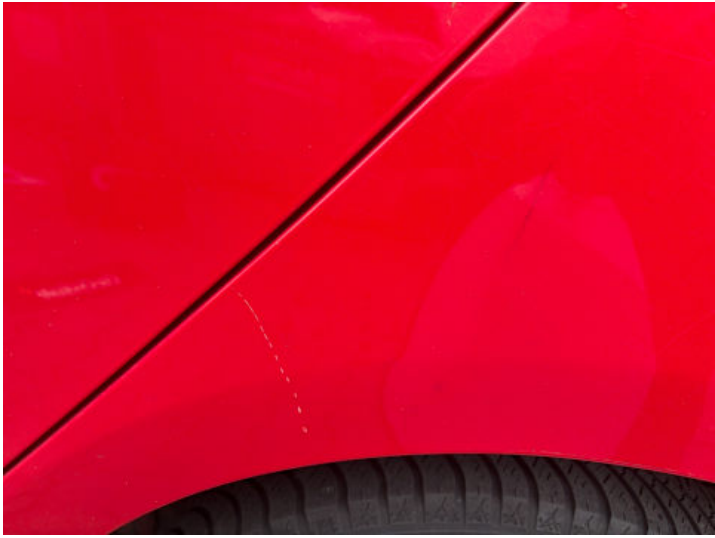
Seitenteil hinten links (Lackschaden, Kratzer)
