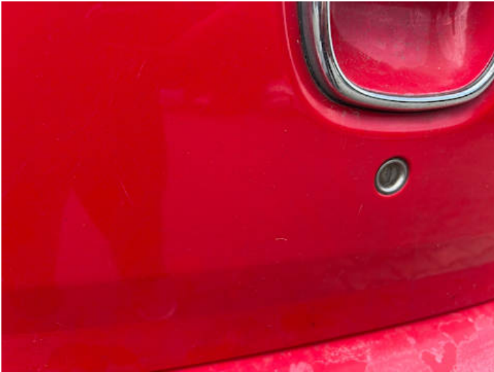
Heckklappe (Lackschaden, Kratzer)
