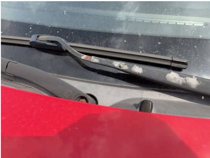
Windschutzscheibe (Anderer Schaden): Scheibenwischergestänge Rost
