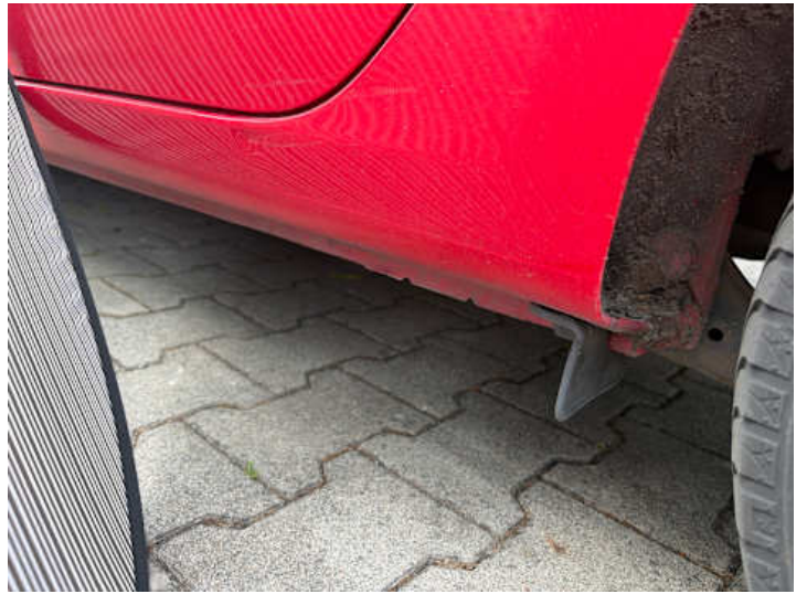
Schweller links (Delle, Verformung, Lackschaden, Kratzer)
