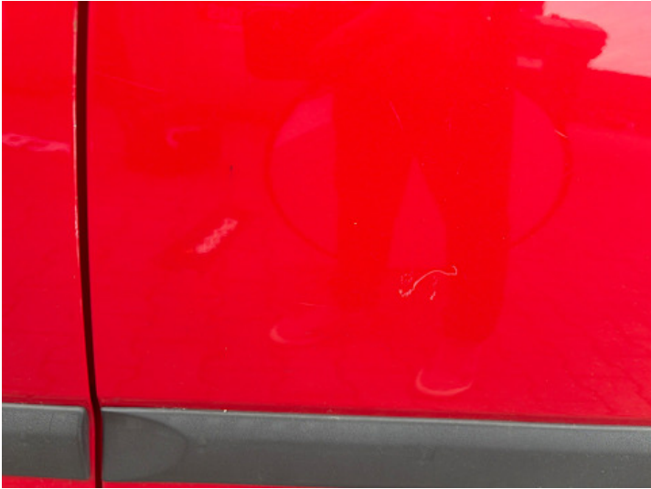
Türe hinten links (Lackschaden, Kratzer)
