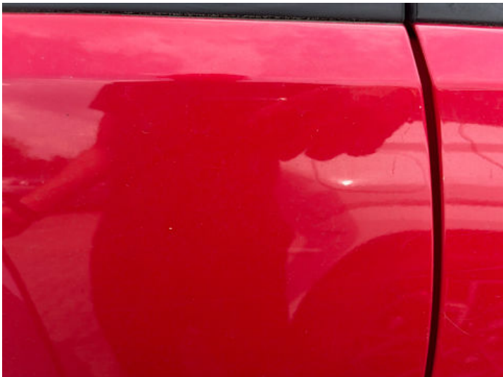
Türe hinten rechts (Lackschaden, Kratzer)
