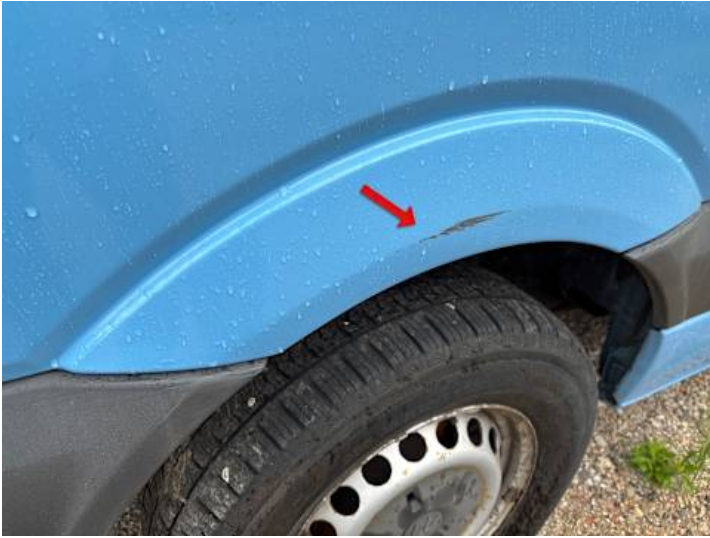
Seitenteil hinten rechts (Kratzer, Delle)
