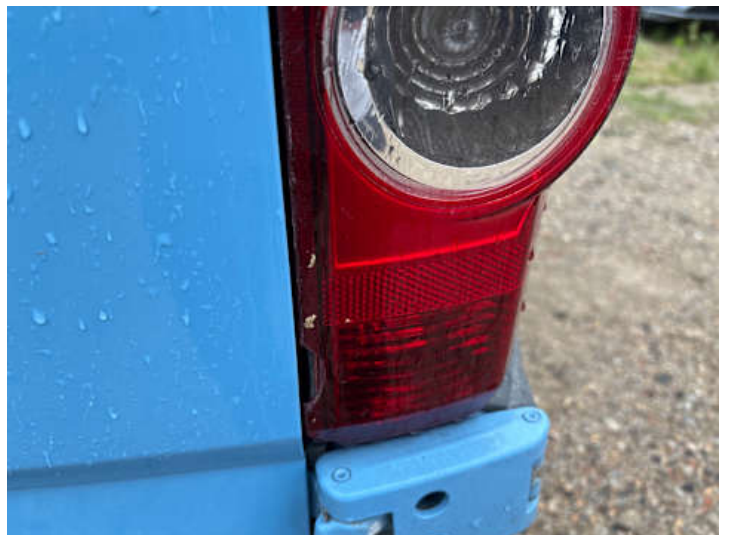
Rücklicht (rechts) (Riss/Bruch)
