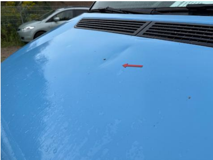
Motorhaube (Delle, Kratzer)
