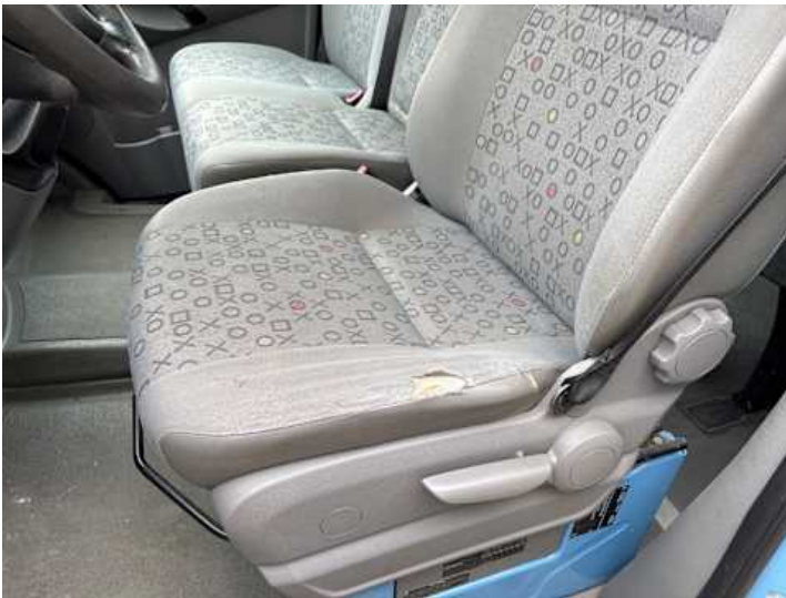
Innenraum (Verschmutzung, Verschleiß, Diverse Schäden)
