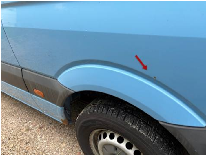
Seitenteil hinten links (Kratzer, Rost)
