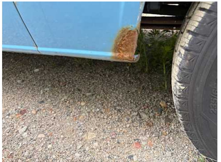
Schweller links (Rost)
