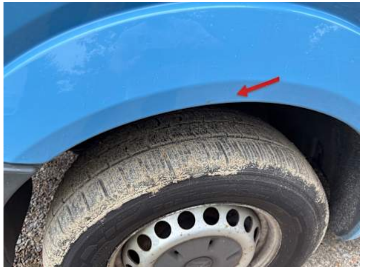
Kotflügel vorne links (Rost)
