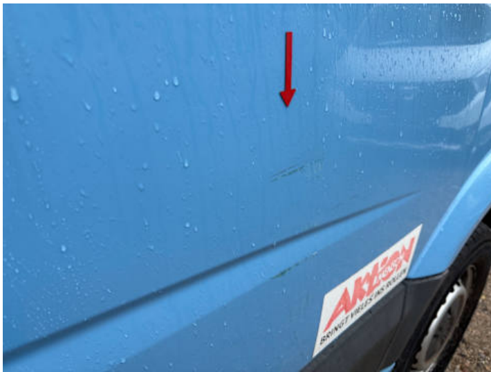
Beifahrertür (Rost, Delle, Kratzer)
