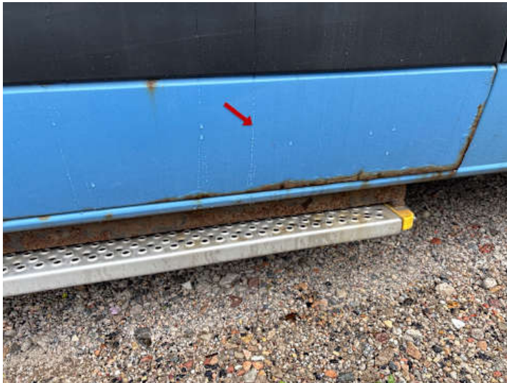
Türe hinten rechts (Rost)
