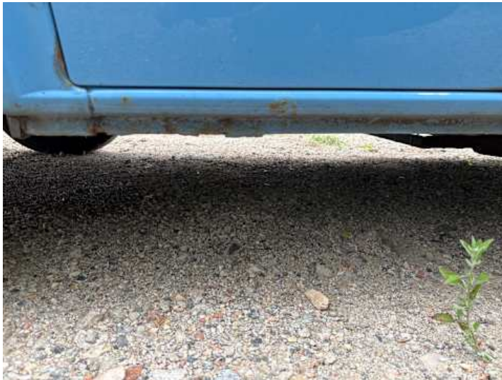
Schweller links (Rost)
