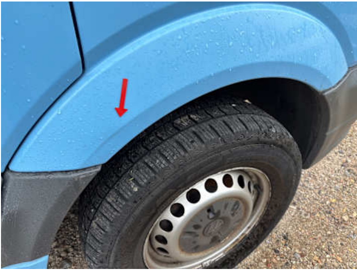
Kotflügel vorne rechts (Rost, Delle, Kratzer)
