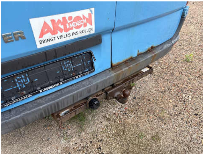
Stoßstange hinten (Verformung, Kratzer)
