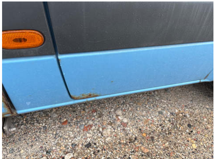
Beifahrertür (Rost, Delle, Kratzer)
