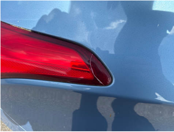
Rücklicht (rechts) (Riss/Bruch)
