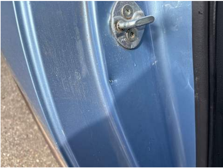
Seitenteil hinten rechts (Lackschaden, Kratzer, Delle)
