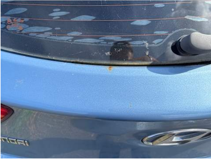
Heckklappe (Rost, Lackschaden)
