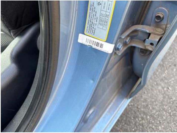
Schweller links (Lackschaden, Delle)
