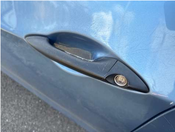
Fahrtür (Lackschaden, Kratzer)
