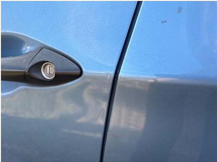
Fahrtür (Lackschaden, Kratzer)
