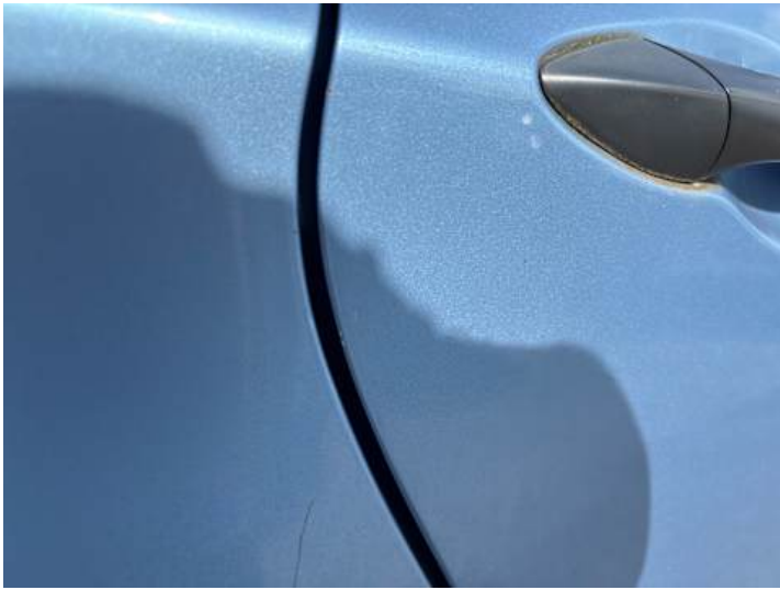
Türe hinten rechts (Kratzer, Lackschaden)
