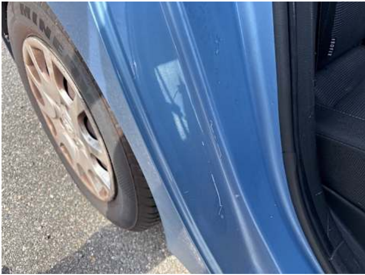
Seitenteil hinten rechts (Lackschaden, Kratzer, Delle)
