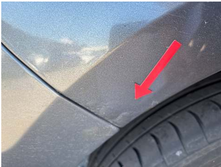
Seitenteil hinten rechts (Rost)
