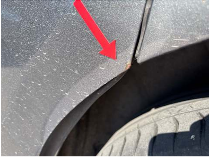
Türe hinten links (Rost)
