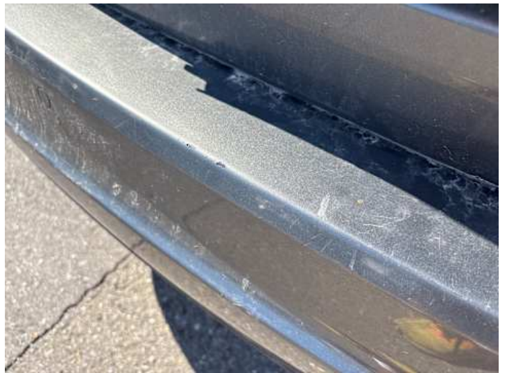
Stoßstange hinten (Kratzer)
