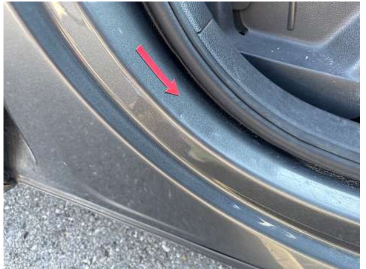
Schweller rechts (Kratzer, Delle)
