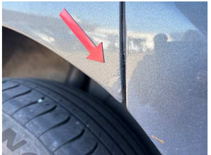
Seitenteil hinten rechts (Rost)
