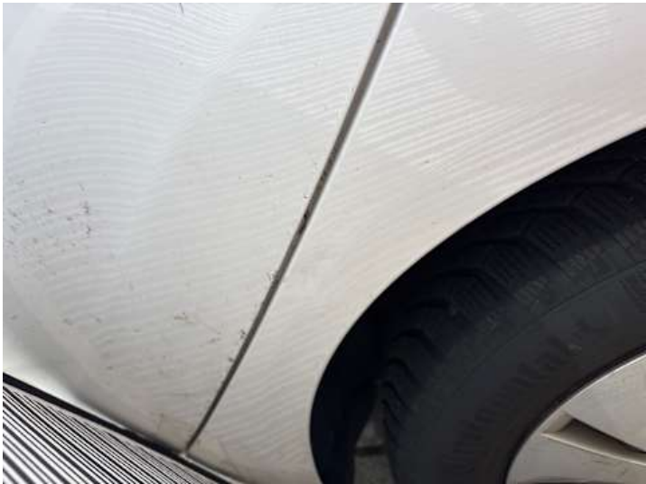
Seitenteil hinten links (Delle, Kratzer)
