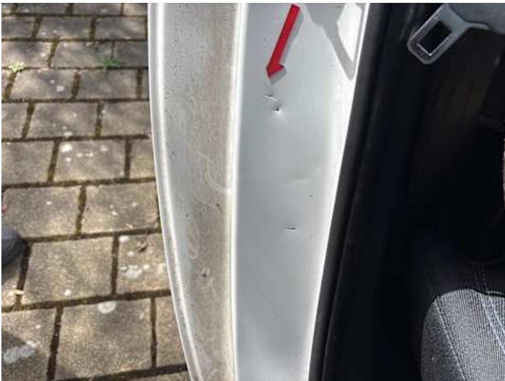
Türe hinten rechts (Delle, Kratzer)
