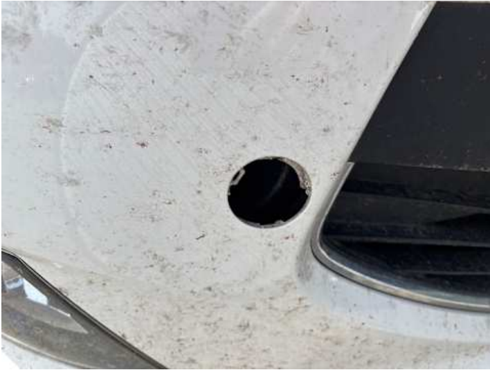
Stoßstange vorne (Kratzer, Anderer Schaden): Teil fehlt
