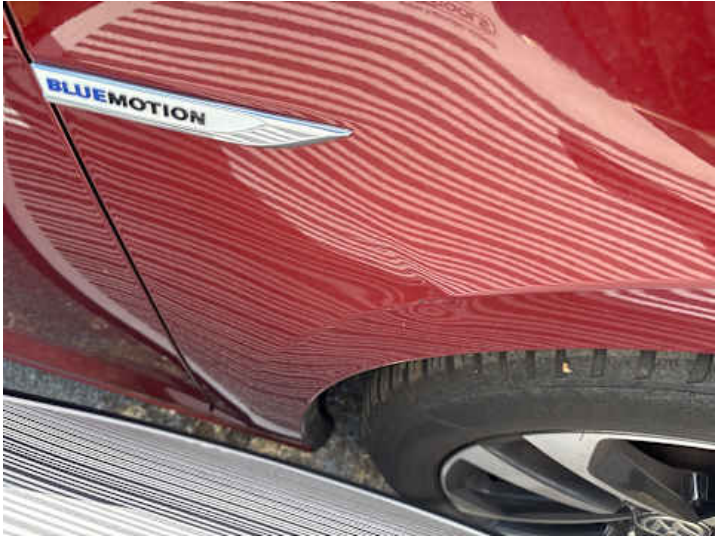
Kotflügel vorne rechts (Kratzer, Verformung)
