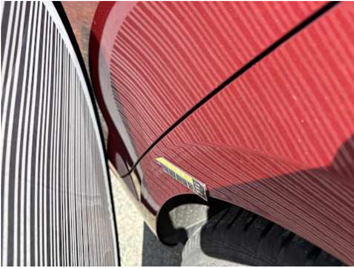
Seitenteil hinten links (Delle)
