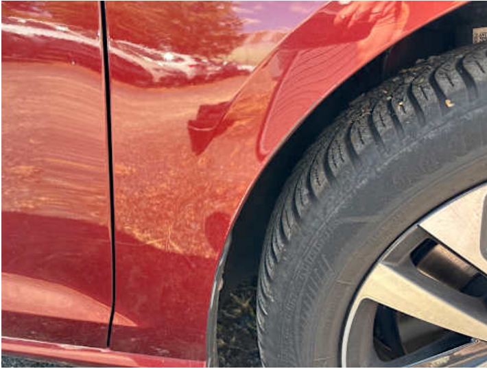
Kotflügel vorne rechts (Kratzer, Verformung)
