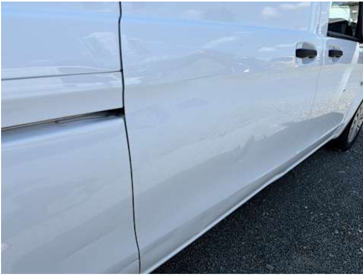
Türe hinten rechts (Delle, Kratzer)
