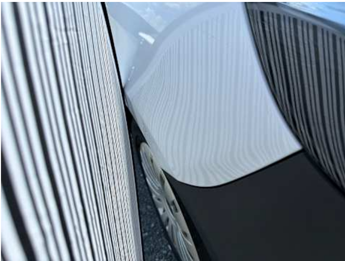
Kotflügel vorne rechts (Unsachgemäß instand gesetzt, Verformung)
