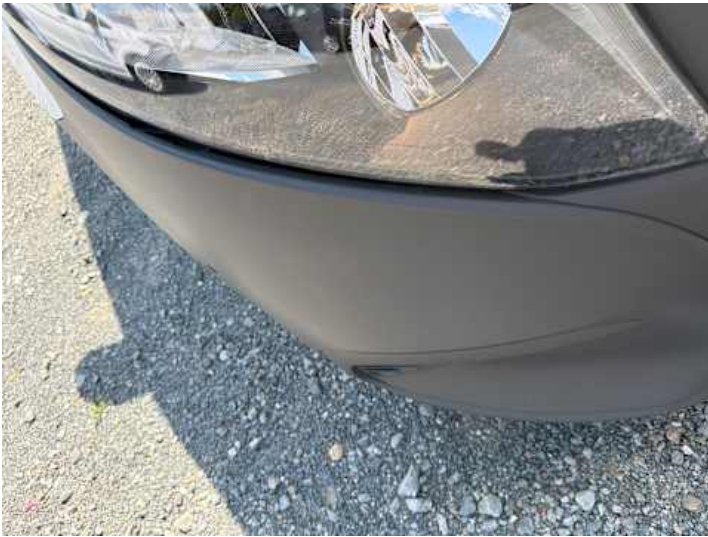
Stoßstange vorne (Spaltmaße ungenau)
