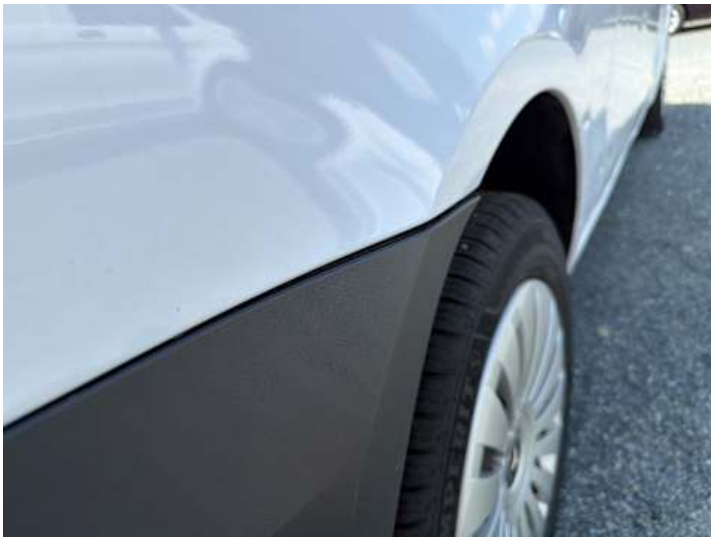
Seitenteil hinten rechts (Spaltmaße ungenau)
