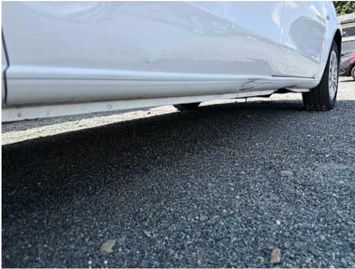
Schweller rechts (Delle, Verformung)
