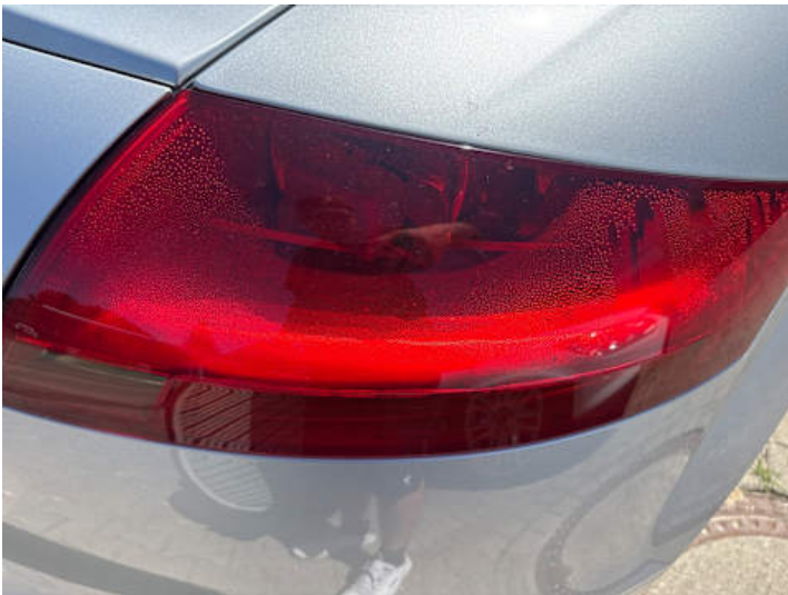
Rücklicht (rechts) (Undicht)
