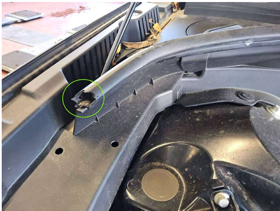
Bild 13 : Motorraum Dichtgummi Tierversiss (lag im Motorraum)
