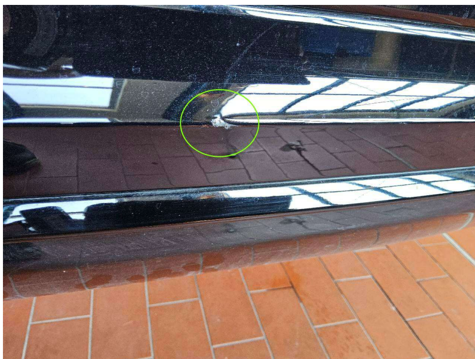
Bild 16 : Stoßfänger hinten leichte Kratzer und mittig Schramme mit leichter Deformierung
