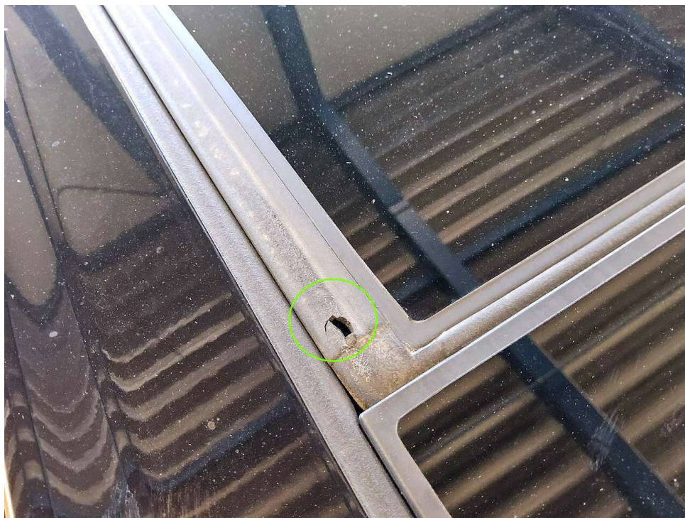
Bild 15 : Panoramadach Dichtgummi beschädigt
