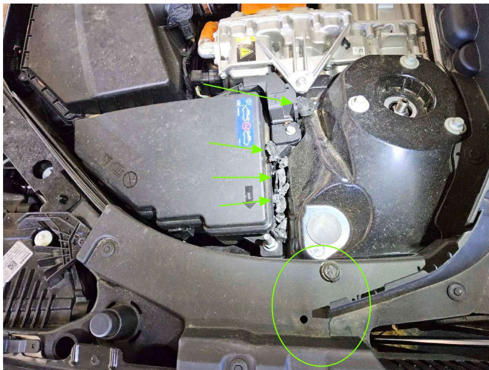
Bild 9 : Motorraumdämmung rechts und links Tierverbiss
