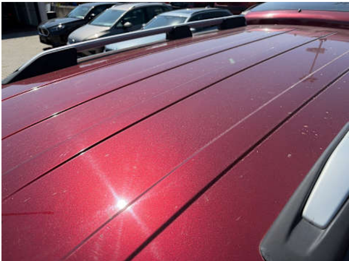
Dach (Kratzer, Lackschaden)
