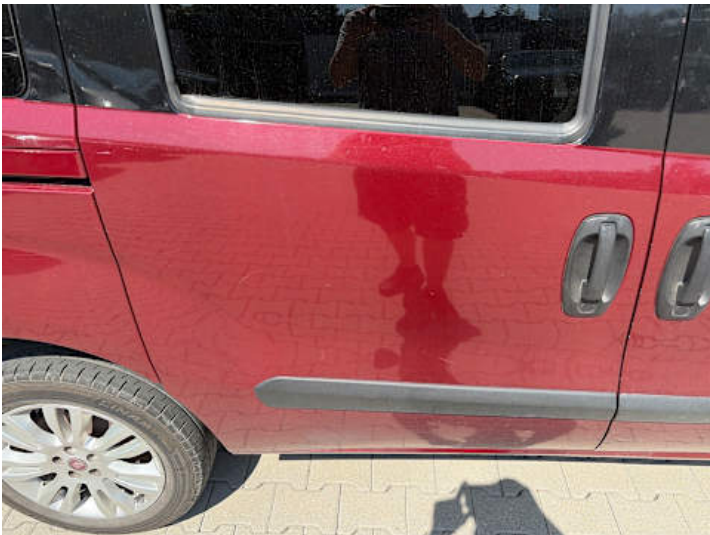
Türe hinten rechts (Kratzer, Lackschaden, Delle)
