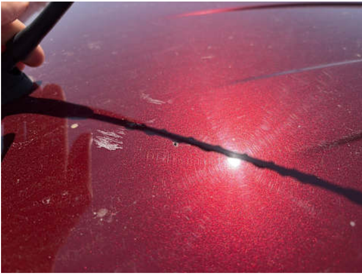
Dach (Kratzer, Lackschaden)
