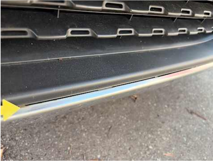
Stoßstange vorne (Spaltmaße ungenau)
