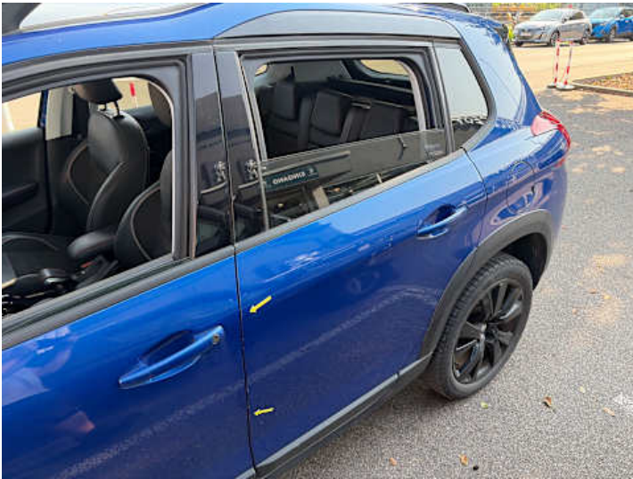
Türe hinten links (Kratzer)
