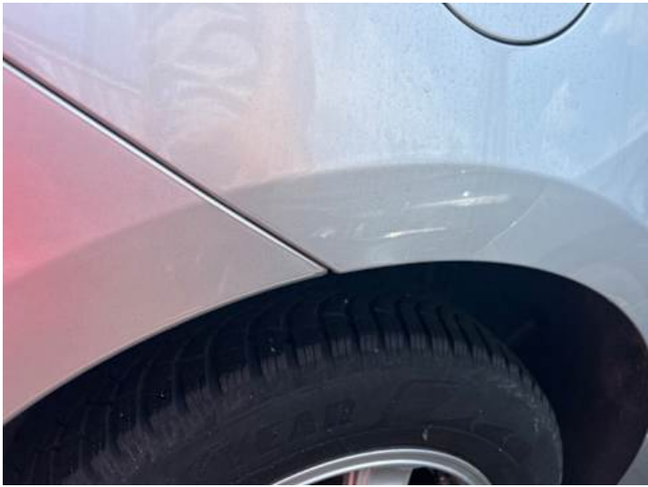
Stoßstange hinten (Spaltmaße ungenau)
