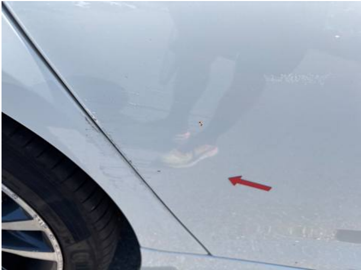
Türe hinten rechts (Kratzer, Verformung)
