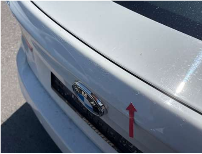
Heckklappe (Lackschaden, Unsachgemäß instand gesetzt)
