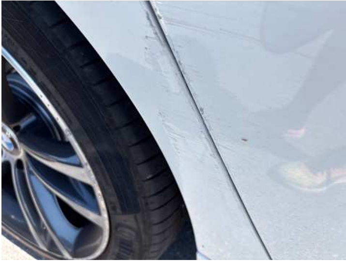
Seitenteil hinten rechts (Kratzer, Verformung)
