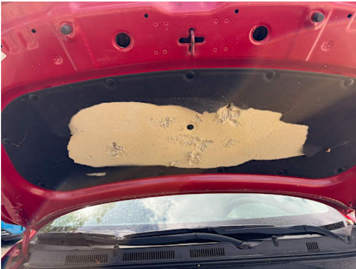
Motorhaube (Riss/Bruch, Anderer Schaden): Hagelschaden
