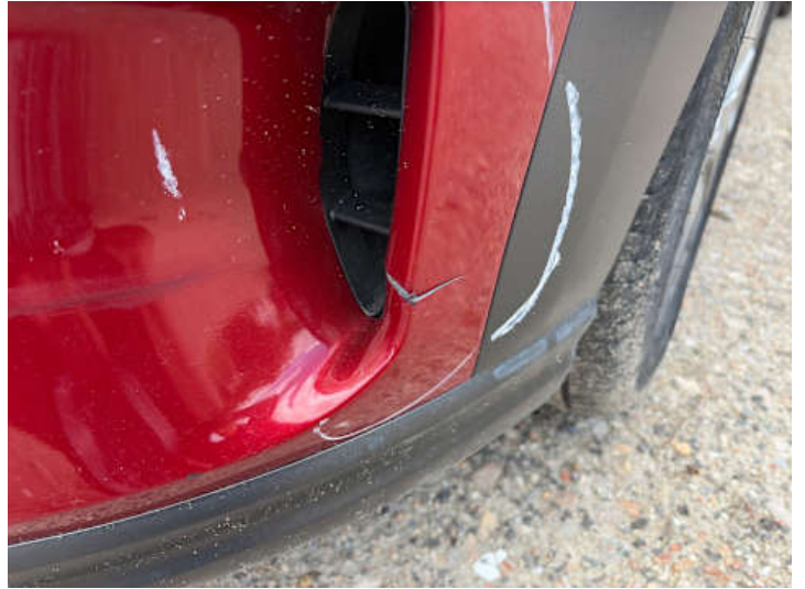
Stoßstange vorne (Riss/Bruch, Kratzer)
