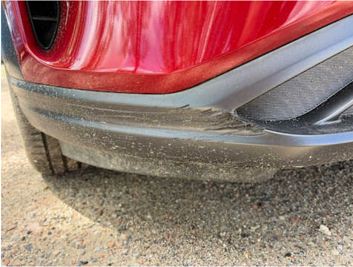
Stoßstange vorne (Riss/Bruch, Kratzer)
