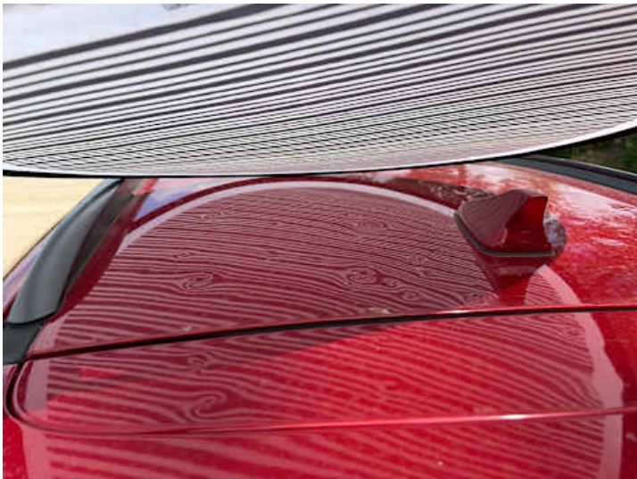
Dach (Delle, Anderer Schaden): Hagelschaden
