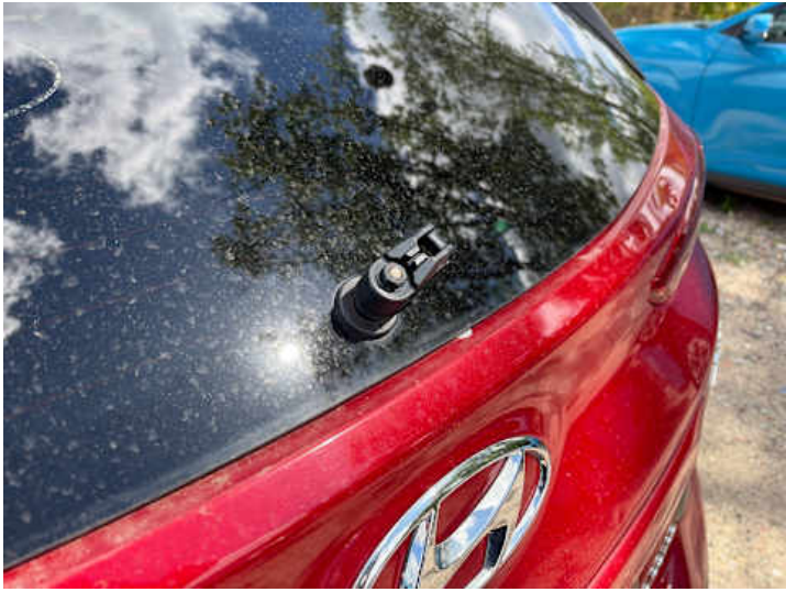
Heckklappe (Delle, Lackschaden, Anderer Schaden): Scheibenwischer fehlt
