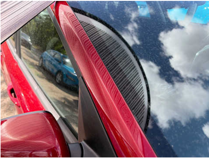
Dach (Delle, Anderer Schaden): Hagelschaden
