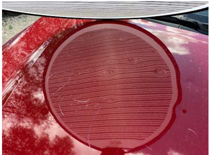
Motorhaube (Riss/Bruch, Anderer Schaden): Hagelschaden
