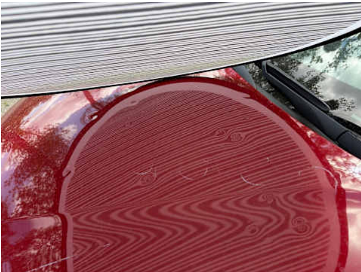
Motorhaube (Riss/Bruch, Anderer Schaden): Hagelschaden
