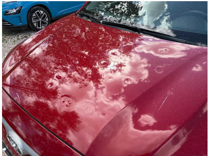
Motorhaube (Riss/Bruch, Anderer Schaden): Hagelschaden
