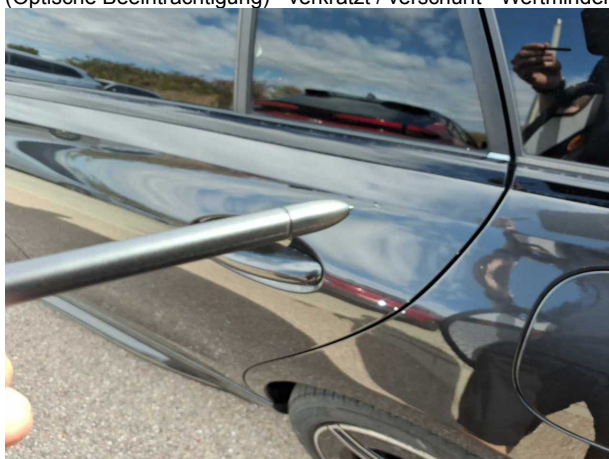
Beschädigung #8: Tür hinten links: Tür - Delle / Lackschaden - Wertminderung
