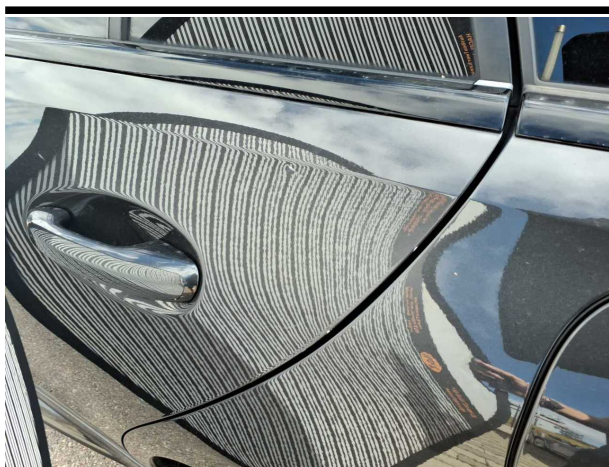
Beschädigung #8: Tür hinten links: Tür - Delle / Lackschaden - Wertminderung
