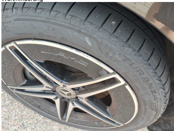
Beschädigung #10: Rad/Reifen: Leichtmetallfelge hinten links (Sicherheitsrelevanter Mangel) - verkratzt / verschürft - erneuern
