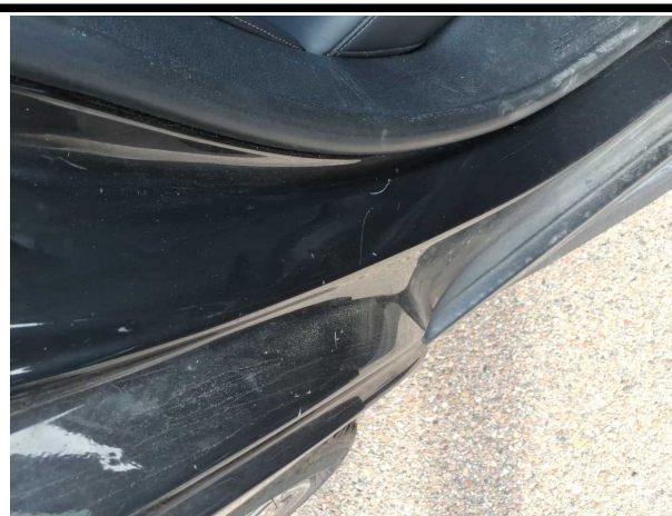
Beschädigung #5: Seitenwand rechts: Einstieg - Kratzer - Wertminderung
