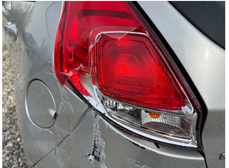
Rücklicht (links) (Riss/Bruch)
