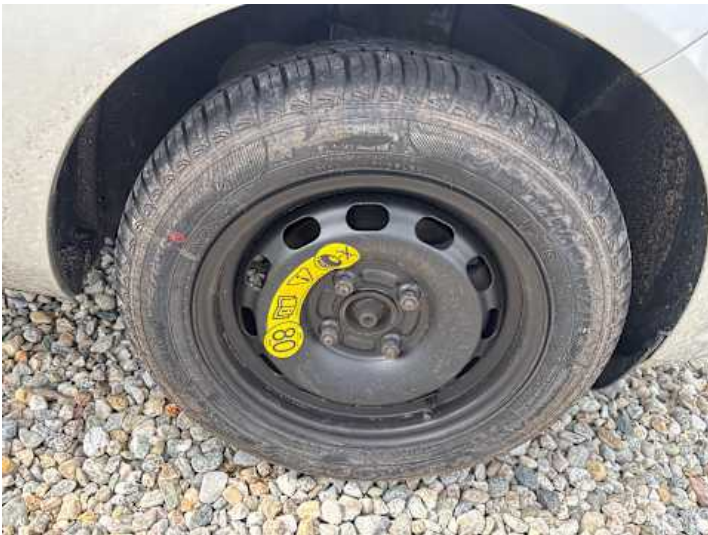
Rad (Anderer Schaden): Notrad verbaut
