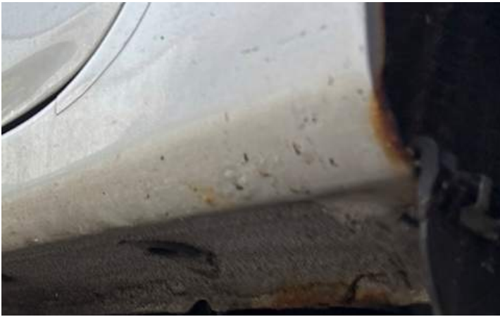
Schweller links (Rost)
