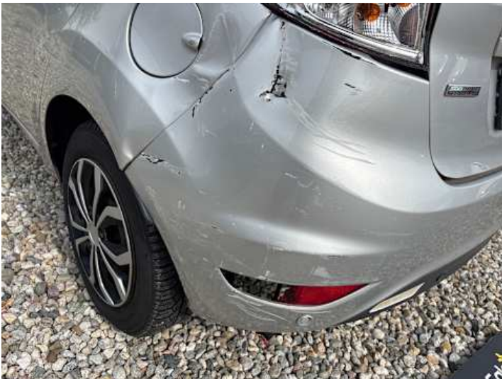
Stoßstange hinten (Kratzer, Verformung, Riss/Bruch)
