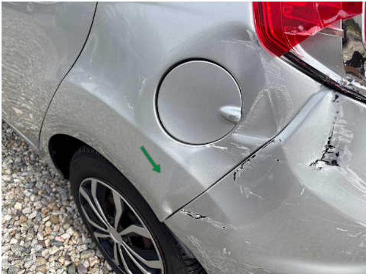
Seitenteil hinten links (Verformung)
