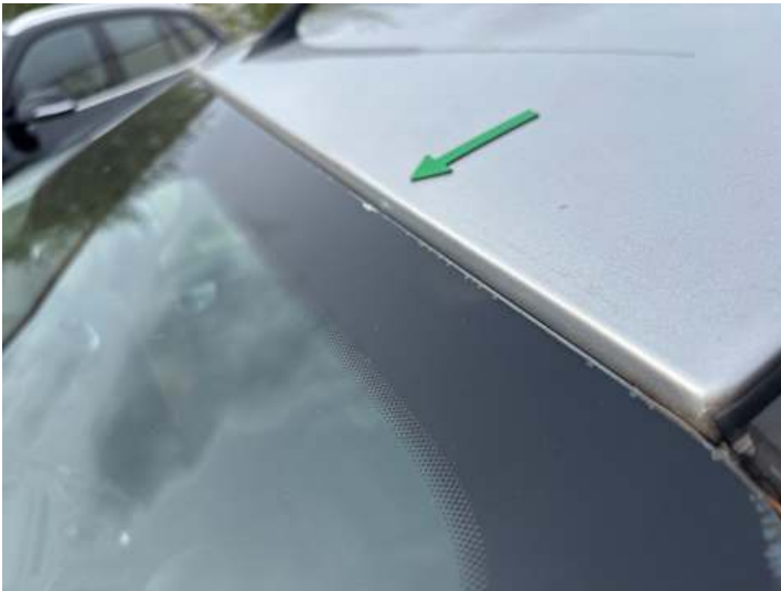
Dach (Anderer Schaden): Ablösung
