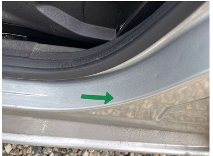
Schweller links (Kratzer, Delle)
