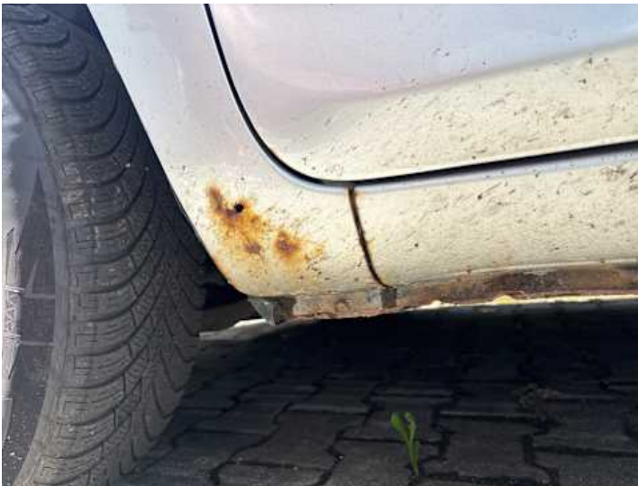
Schweller links (Rost, Lackschaden)
