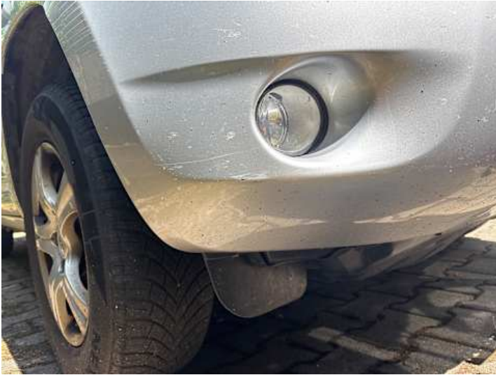
Stoßstange vorne (Kratzer, Lackschaden)
