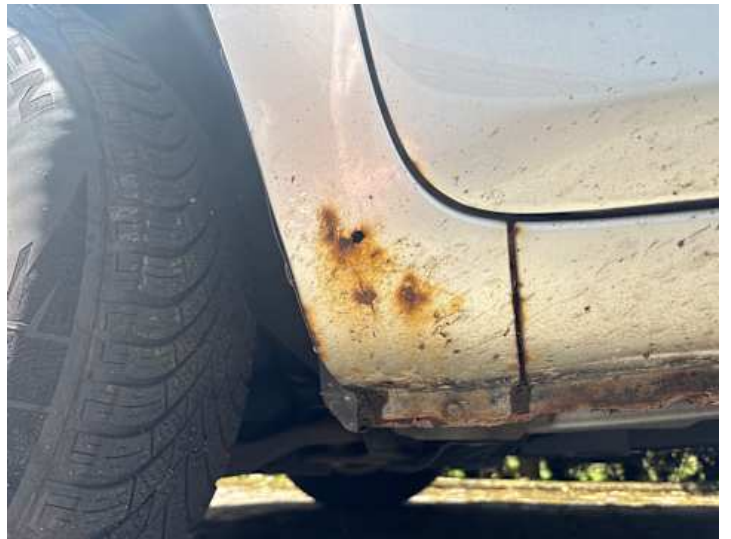
Kotflügel vorne links (Lackschaden, Rost)
