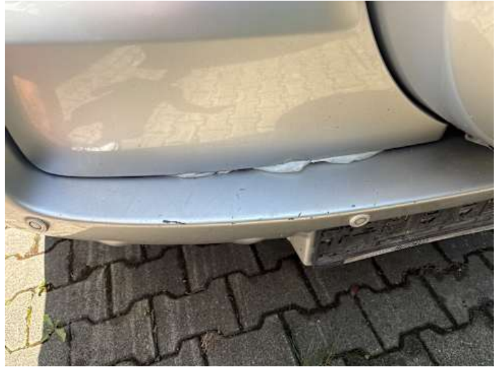
Stoßstange hinten (Kratzer, Lackschaden)
