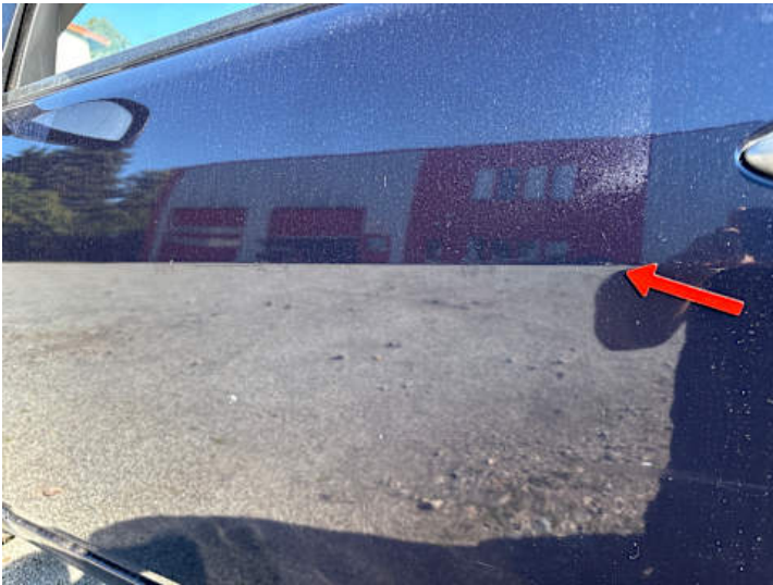
Fahrtür (Kratzer, Delle)
