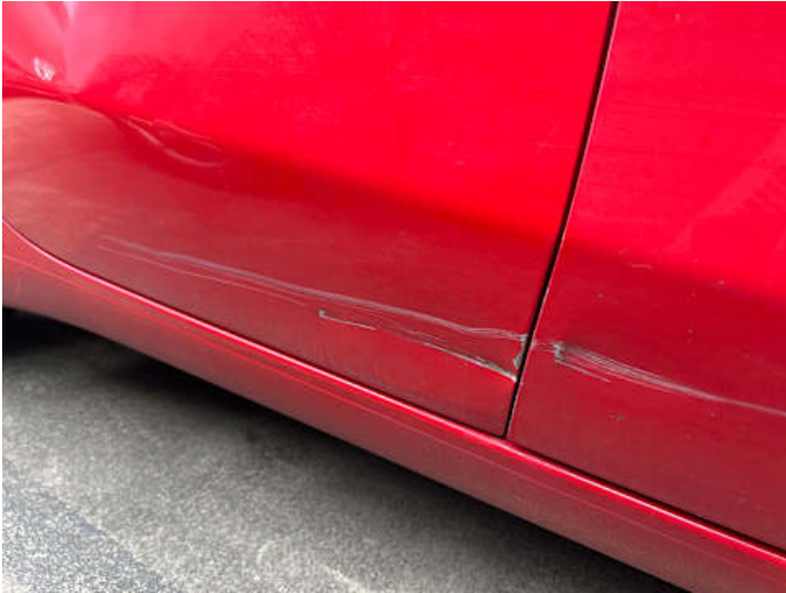
Türe hinten rechts (Kratzer, Verformung)
