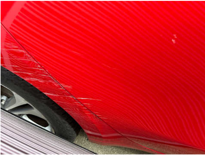
Türe hinten rechts (Kratzer, Verformung)
