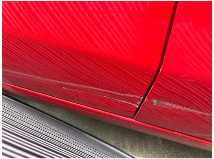
Türe hinten rechts (Kratzer, Verformung)
