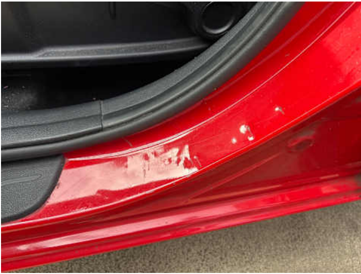
Schweller links (Kratzer, Delle)
