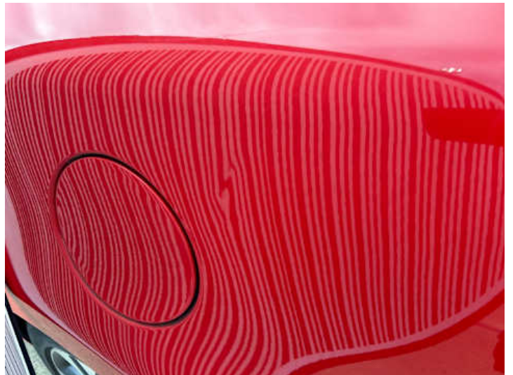
Seitenteil hinten links (Verformung)
