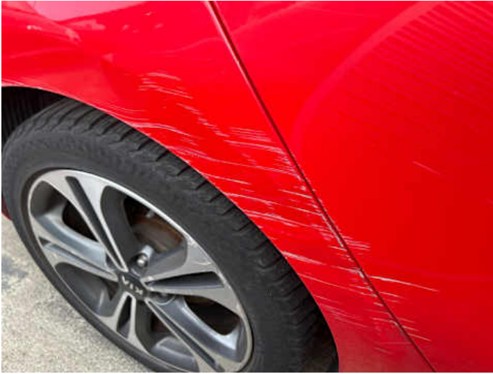
Seitenteil hinten rechts (Verformung)
