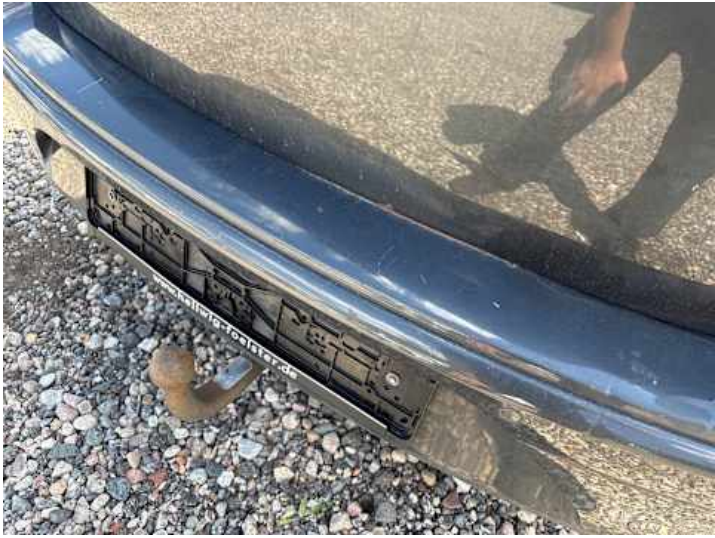
Stoßstange hinten (Kratzer, Lackschaden)
