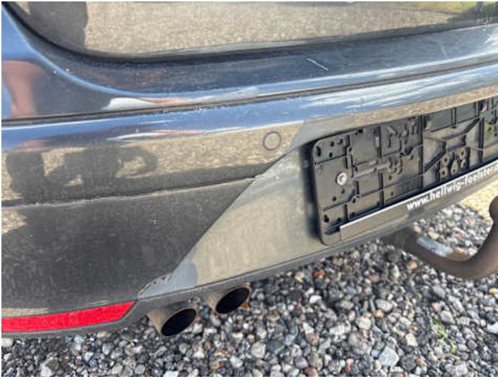
Stoßstange hinten (Kratzer, Lackschaden)
