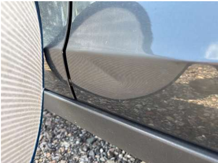
Türe hinten links (Lackschaden, Kratzer, Delle)
