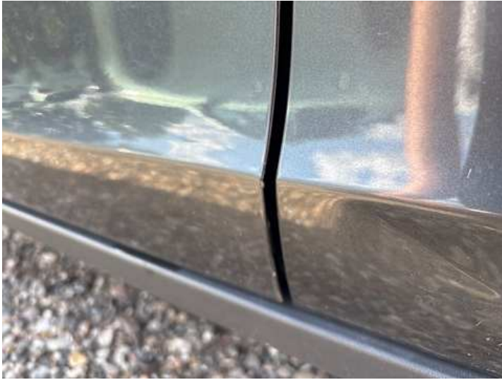
Fahrtür (Delle, Kratzer, Lackschaden)
