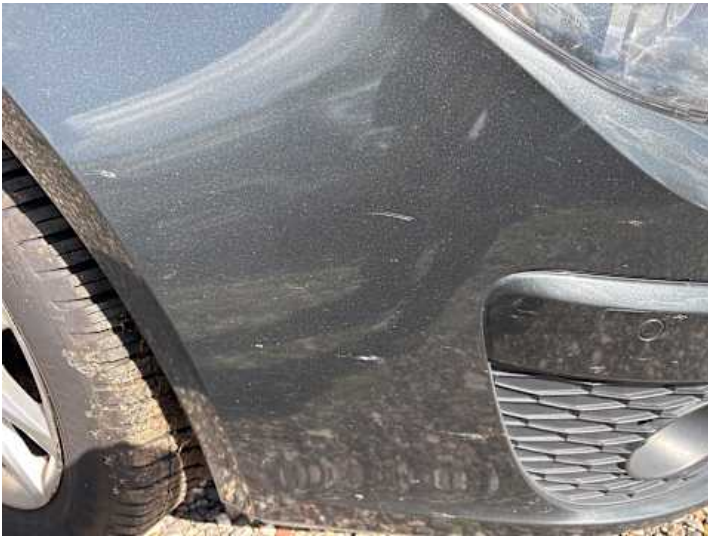
Stoßstange vorne (Kratzer, Lackschaden)
