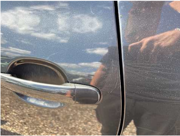
Türe hinten links (Lackschaden, Kratzer, Delle)
