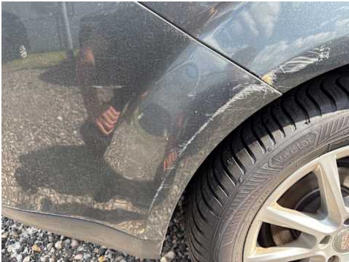
Stoßstange hinten (Kratzer, Lackschaden)
