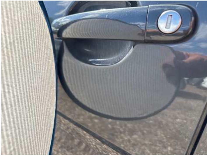
Fahrtür (Delle, Kratzer, Lackschaden)
