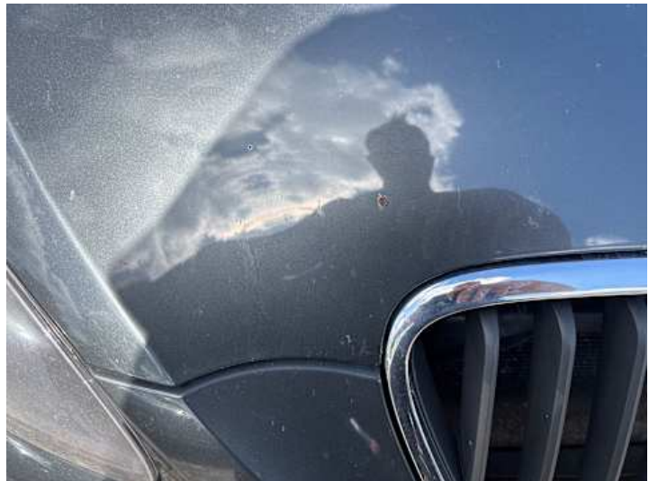
Motorhaube (Lackschaden, Rost)
