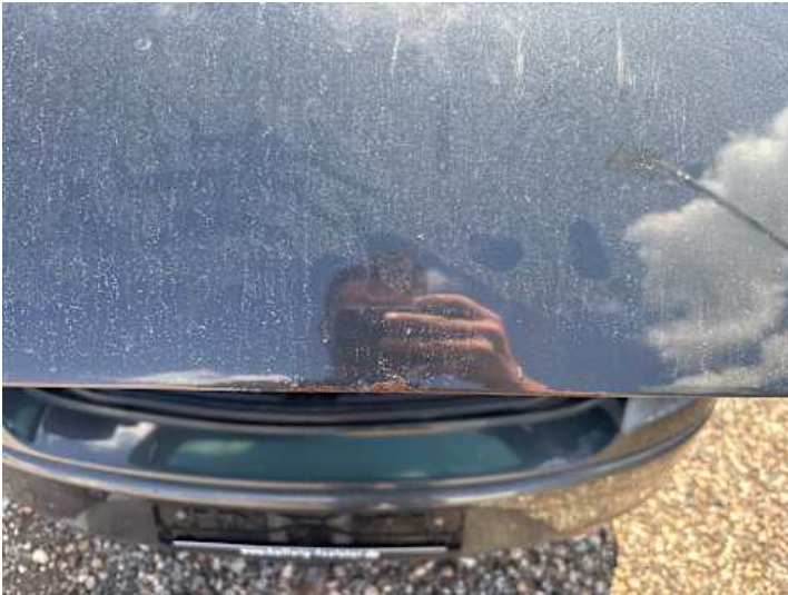
Heckklappe (Delle, Rost, Lackschaden, Kratzer)
