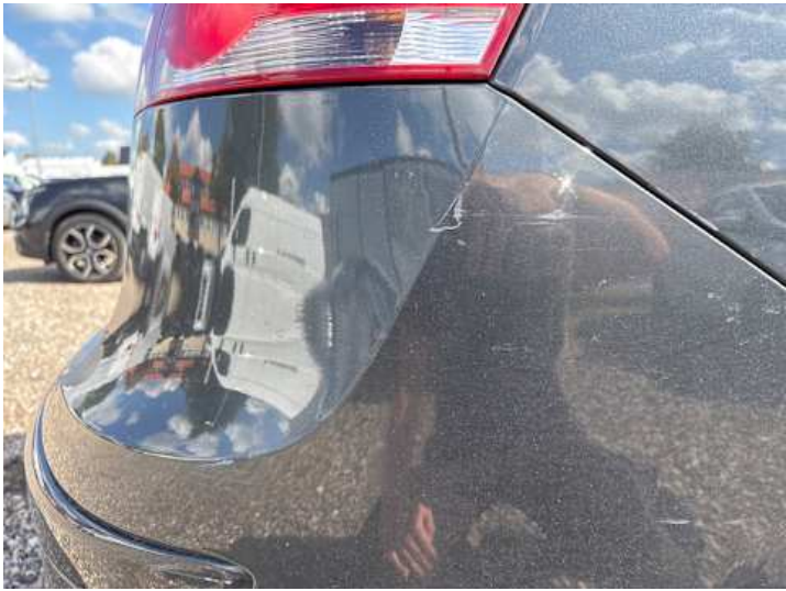
Stoßstange hinten (Kratzer, Lackschaden)
