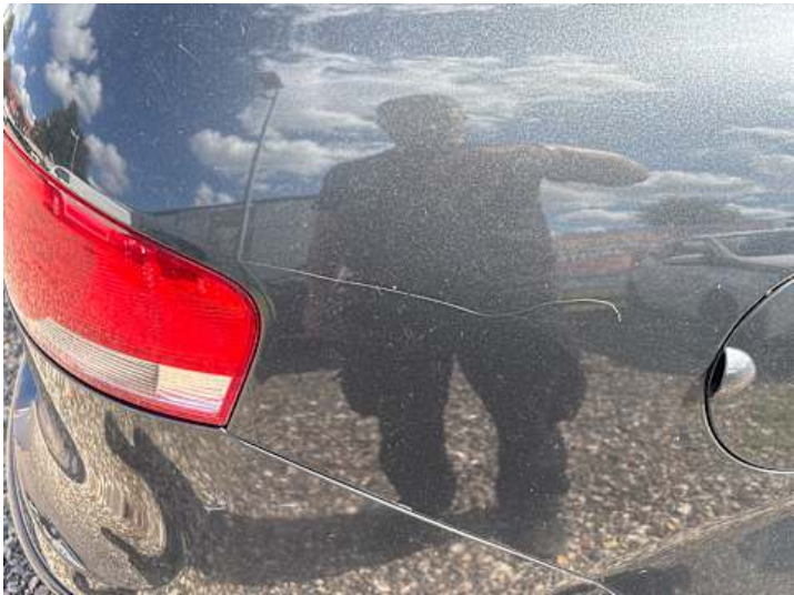
Seitenteil hinten rechts (Lackschaden, Kratzer, Delle)
