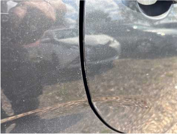
Türe hinten rechts (Delle, Kratzer, Lackschaden)
