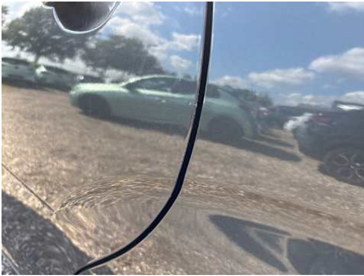
Türe hinten links (Lackschaden, Kratzer, Delle)
