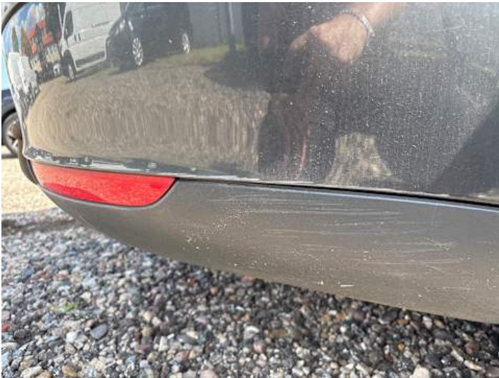
Stoßstange hinten (Kratzer, Lackschaden)
