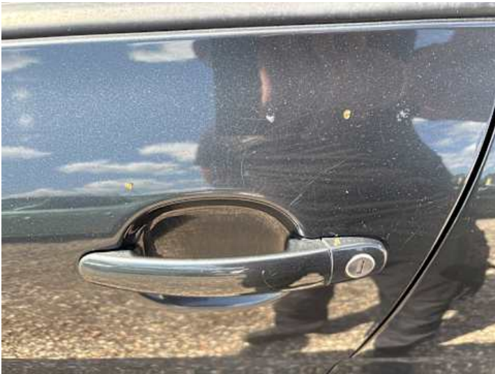
Fahrertür (Delle, Kratzer, Lackschaden)
