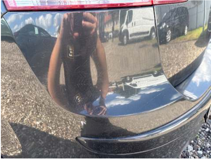
Stoßstange hinten (Kratzer, Lackschaden)
