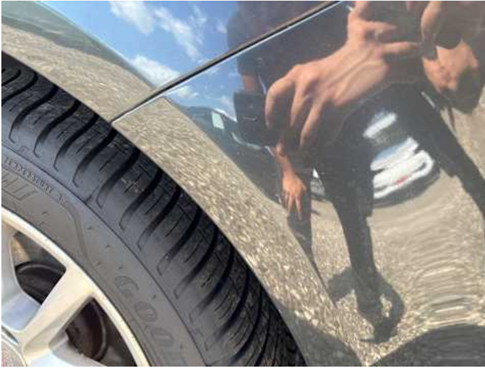
Stoßstange hinten (Kratzer, Lackschaden)
