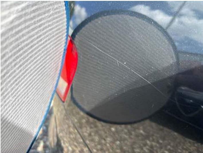
Seitenteil hinten rechts (Lackschaden, Kratzer, Delle)
