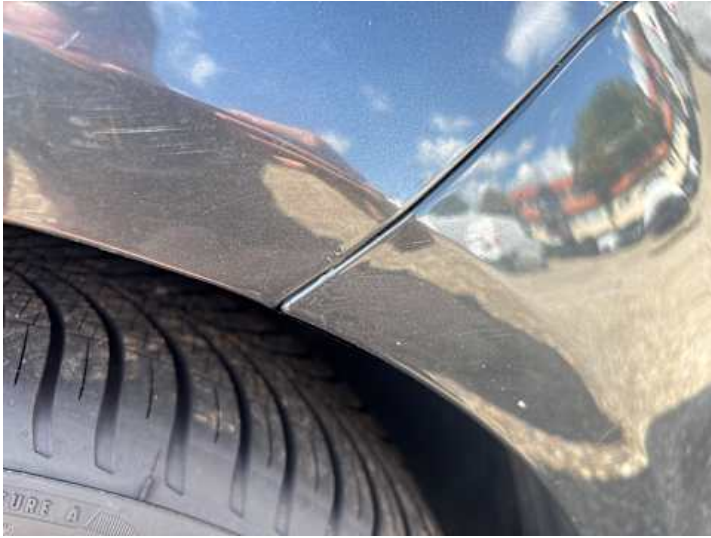
Seitenteil hinten links (Kratzer, Rost)
