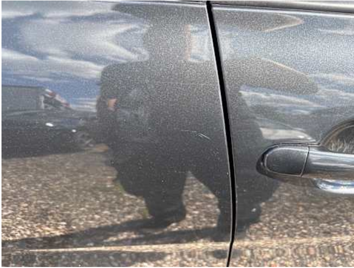
Türe hinten rechts (Delle, Kratzer, Lackschaden)
