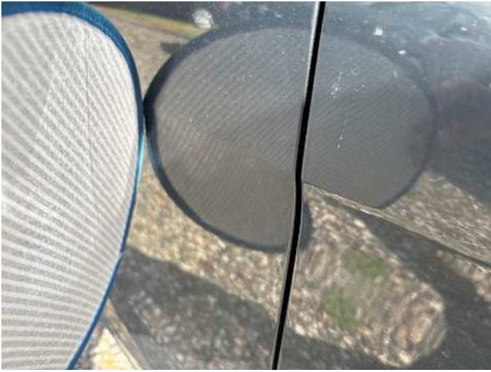
Türe hinten rechts (Delle, Kratzer, Lackschaden)
