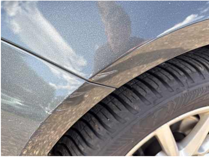
Kotflügel vorne links (Lackschaden, Kratzer)
