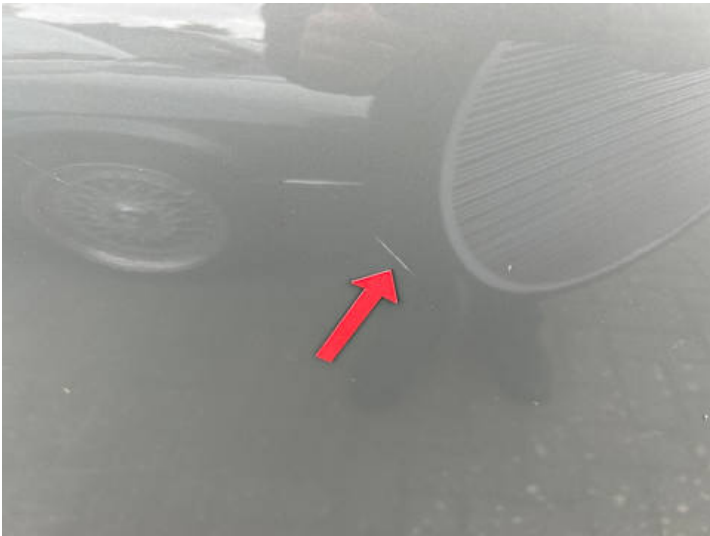
Türe hinten rechts (Delle, Kratzer)
