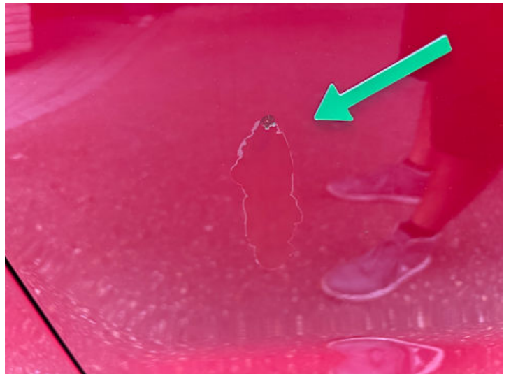
Fahrtür (Lackschaden, Ausgeblichen/Matt)
