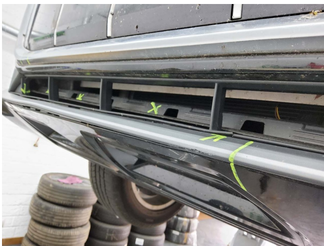
Frontspoiler, Luftführungsgitter mit Blende und Schließteil beschädigt (gebrochen) (DEKRA)
