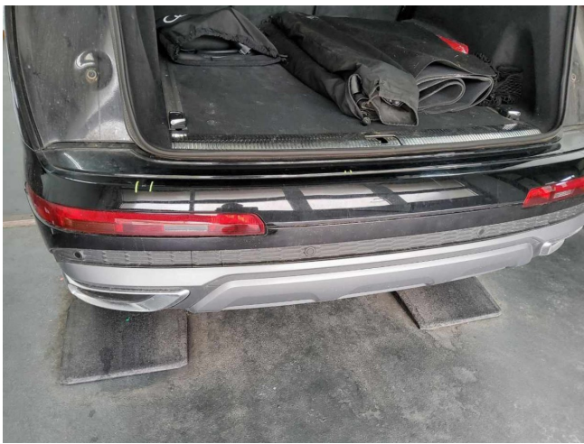
Stoßfänger hinten Lackierung, verschrammt, smart repair (DEKRA)
