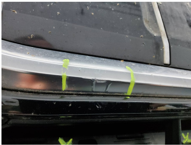
Kühlergrill beschädigt (DEKRA)
