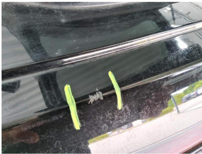
Stoßfänger hinten Lackierung, verschrammt, smart repair (DEKRA)
