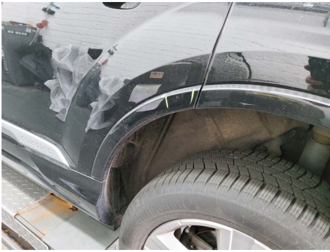
Radlaufabdeckung hinten links verschrammt (DEKRA)
