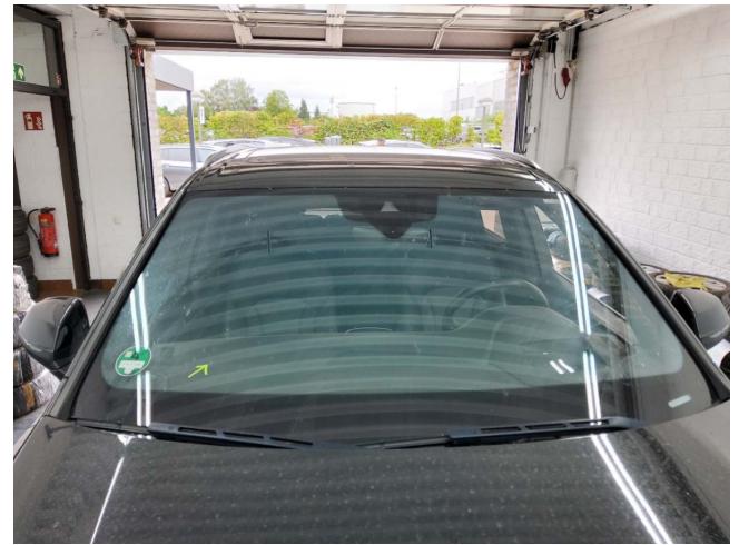
Windschutzscheibe Steinschlag mit Rissbildung (DEKRA)
