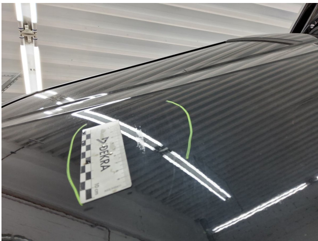
Tür hinten rechts unsachgemäß lackiert, Orangenhaut und Silikoneinschlüsse (DEKRA)
