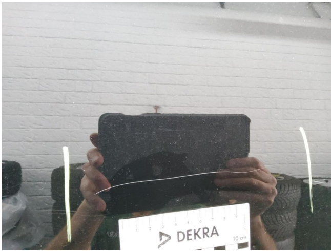
Tür hinten links Lackierung, zerkratzt, lackieren mit Lackaufbau (DEKRA)
