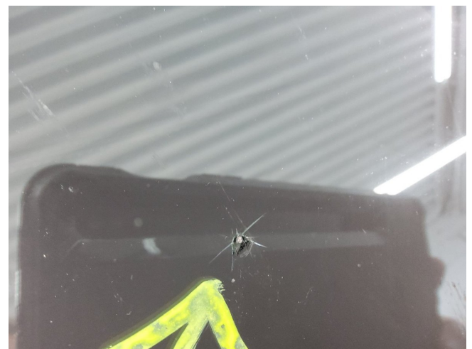
Windschutzscheibe Steinschlag mit Rissbildung (DEKRA)
