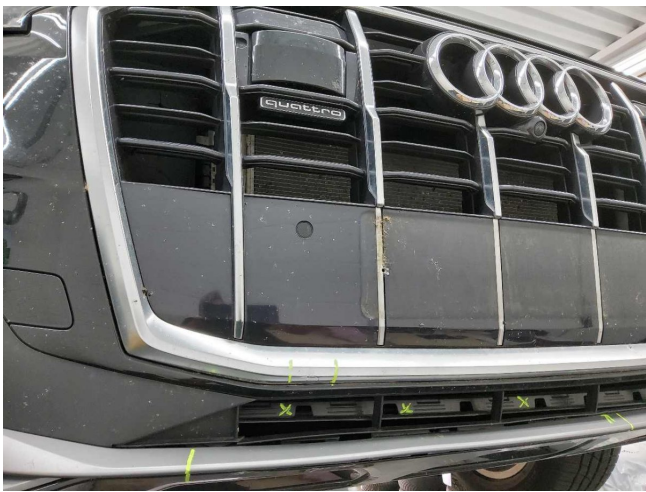
Kühlergrill beschädigt (DEKRA)
