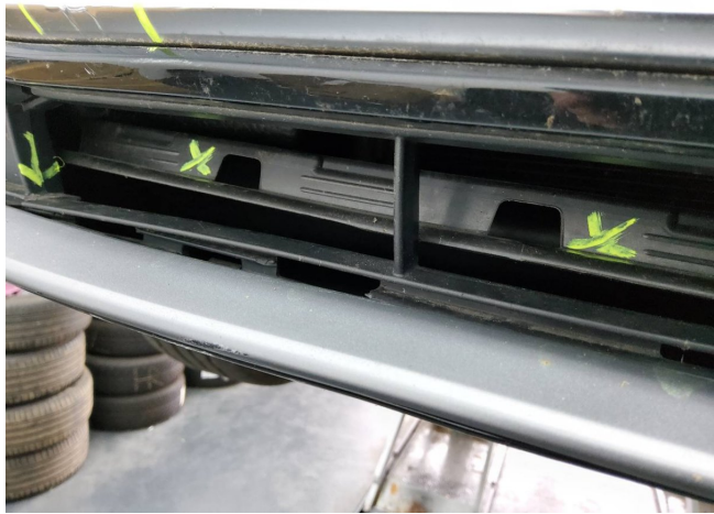
Frontspoiler, Luftführungsgitter mit Blende und Schließteil beschädigt (gebrochen) (DEKRA)
