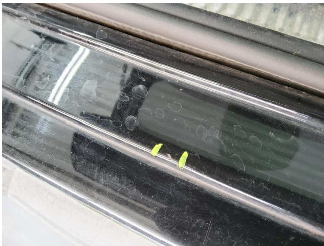
Stoßfänger hinten Lackierung, verschrammt, smart repair (DEKRA)
