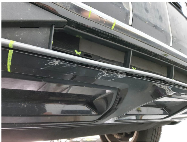
Frontspoiler, Luftführungsgitter mit Blende und Schließteil beschädigt (gebrochen) (DEKRA)
