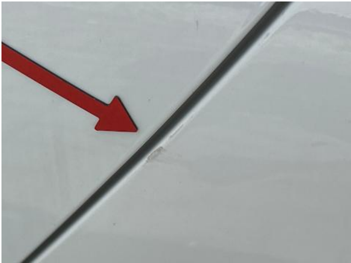
Seitenteil hinten links (Kratzer)
