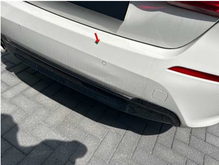
Stoßstange hinten (Kratzer, Verformung)
