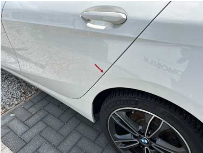
Seitenteil hinten links (Kratzer)
