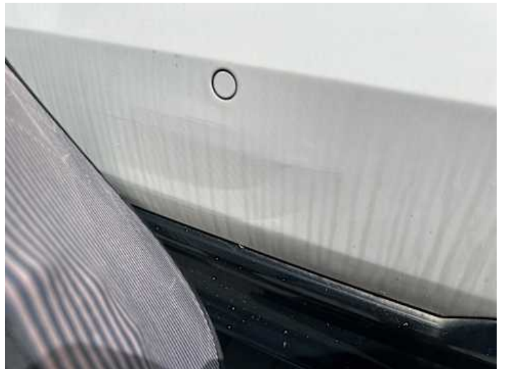
Stoßstange hinten (Kratzer, Verformung)
