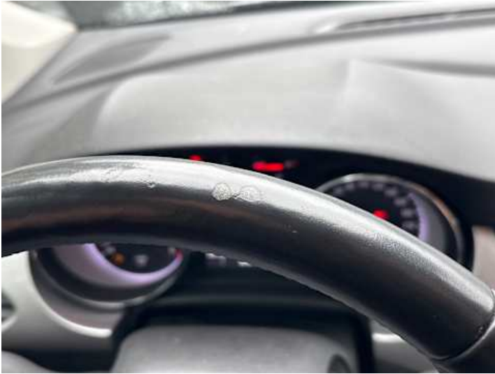
Innenraum (Verschleiß, Kratzer)
