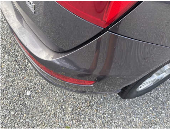
Stoßstange hinten (Kratzer, Spaltmaße ungenau)
