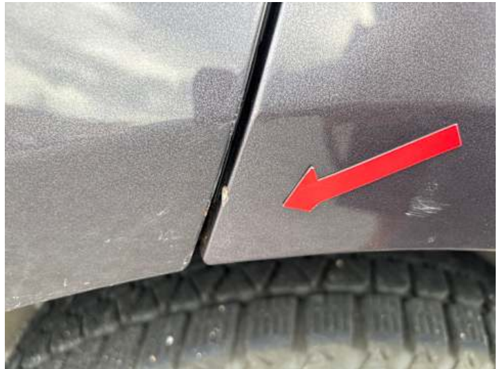
Seitenteil hinten links (Rost)
