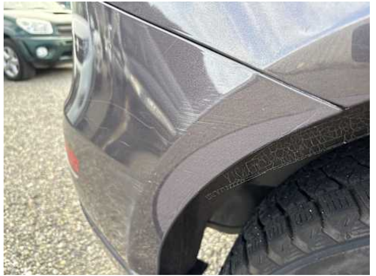
Stoßstange hinten (Kratzer, Spaltmaße ungenau)
