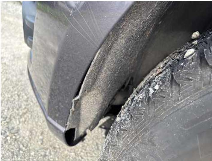
Stoßstange vorne (Unsachgemäß instand gesetzt)
