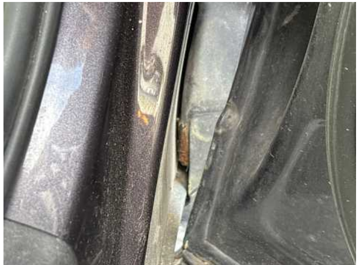
Kotflügel vorne rechts (Rost)
