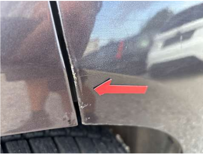
Türe hinten rechts (Lackschaden)
