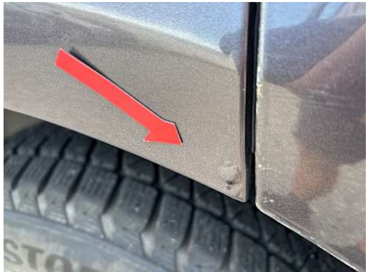
Seitenteil hinten rechts (Rost)
