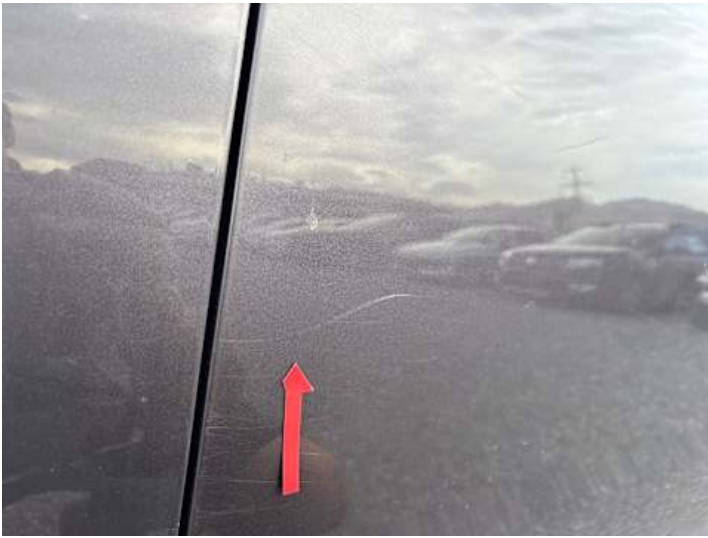
Türe hinten links (Kratzer, Lackschaden)
