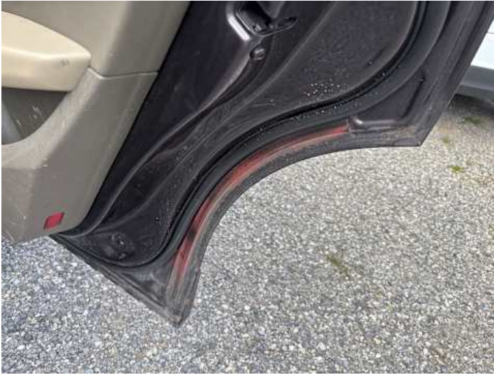
Türe hinten rechts (Unsachgemäß instand gesetzt)
