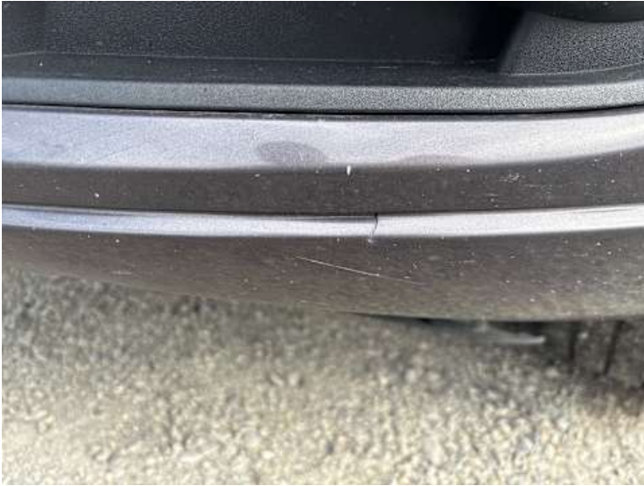
Stoßstange vorne (Riss/Bruch)
