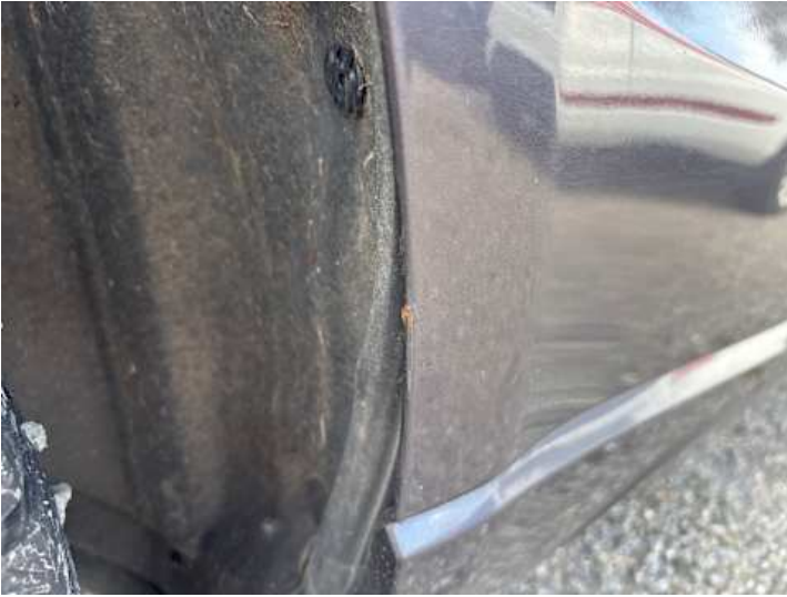
Türe hinten rechts (Rost)
