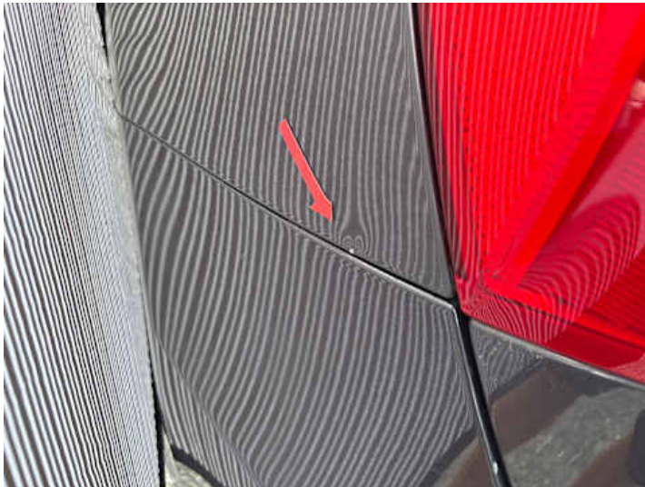
Seitenteil hinten links (Delle, Lackschaden)
