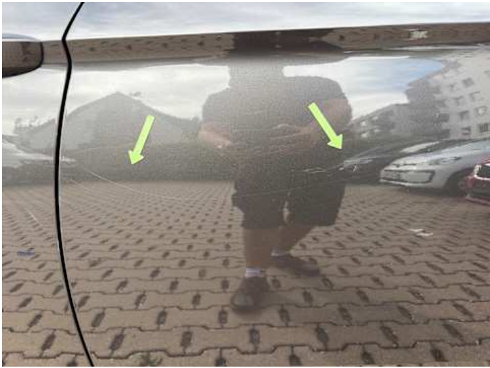
Türe hinten links (Kratzer)
