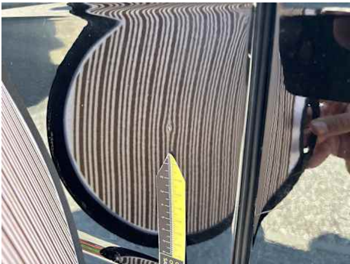
Heckklappe (Delle, Kratzer, Lackschaden)
