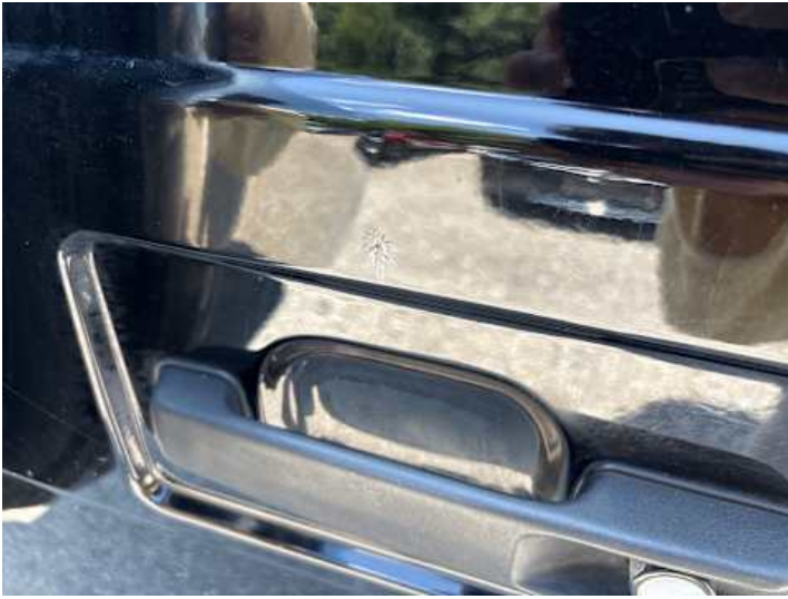
Heckklappe (Rost, Lackschaden)
