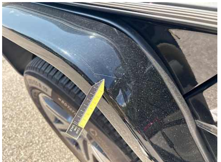
Kotflügel vorne links (Kratzer, Lackschaden)
