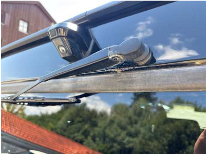
Heckklappe (Rost, Lackschaden)
