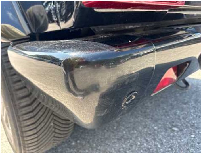
Stoßstange hinten (Ausgeblichen/Matt, Lackschaden, Kratzer, Riss/Bruch)
