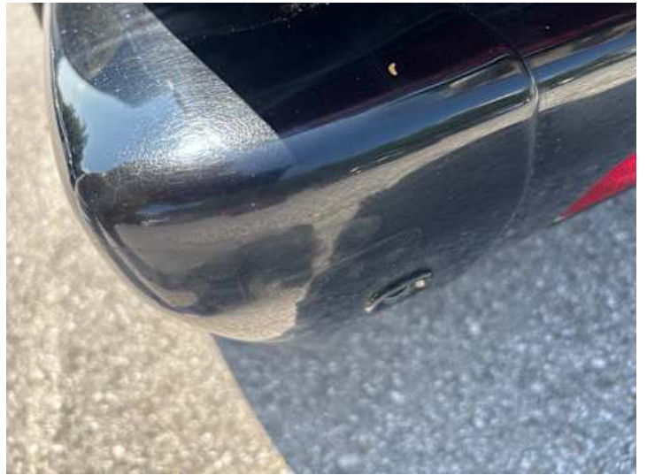
Stoßstange hinten (Ausgeblichen/Matt, Lackschaden, Kratzer, Riss/Bruch)
