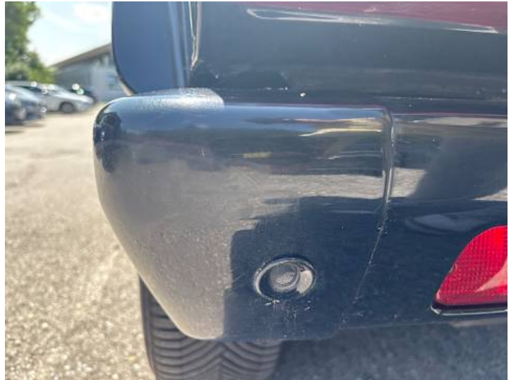
Stoßstange hinten (Ausgeblichen/Matt, Lackschaden, Kratzer, Riss/Bruch)
