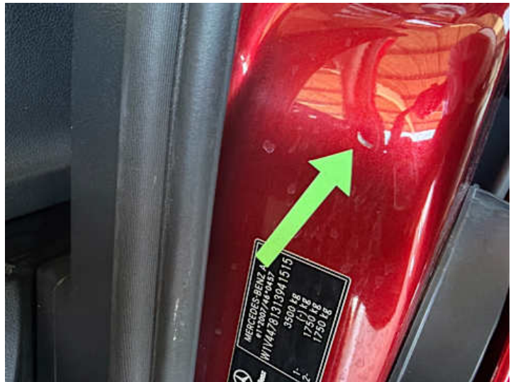
Schweller links (Kratzer)
