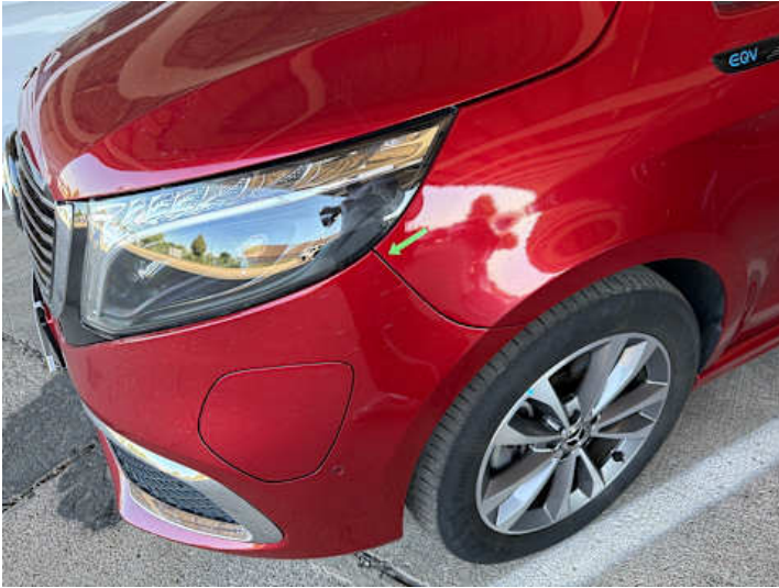
Stoßstange vorne (Spaltmaße ungenau)
