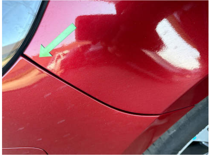
Stoßstange vorne (Spaltmaße ungenau)
