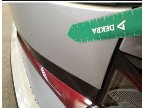
Heckklappe / Kofferraumtür / Mitte Mitte / Kratzer
