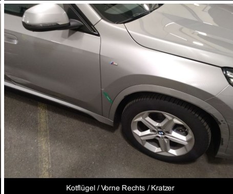
Kotflügel / Vorne Rechts / Kratzer
