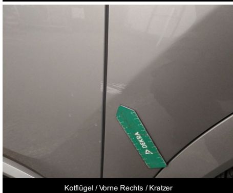
Kotflügel / Vorne Rechts / Kratzer
