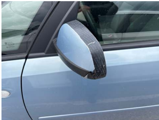
Fahrtür (Unsachgemäß instand gesetzt)
