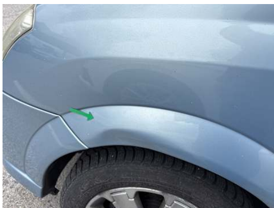
Kotflügel vorne links (Delle)
