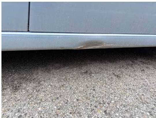
Schweller rechts (Verformung)
