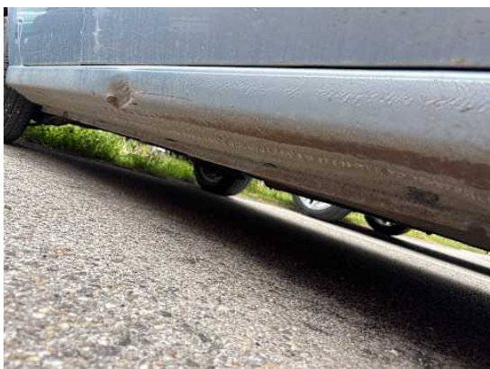
Schweller rechts (Verformung)
