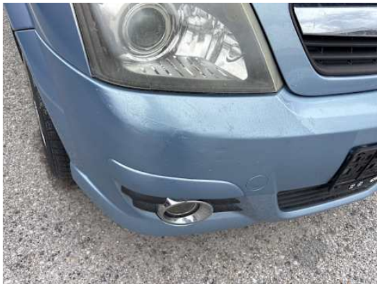
Stoßstange vorne (Unsachgemäß instand gesetzt, Lackschaden)
