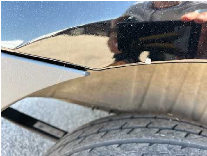
Seitenteil hinten rechts (Rost, Steinschlag)
