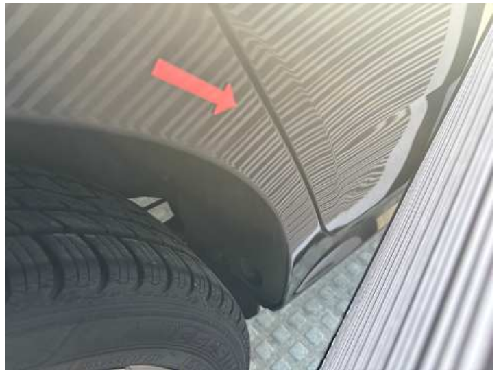
Seitenteil hinten rechts (Verformung)
