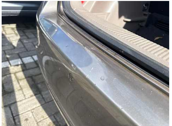
Stoßstange hinten (Lackschaden, Riss/Bruch, Verformung)
