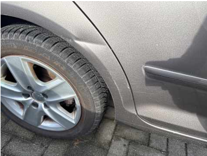
Seitenteil hinten rechts (Lackschaden, Verformung, Kratzer)
