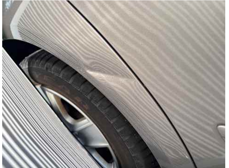
Seitenteil hinten rechts (Lackschaden, Verformung, Kratzer)
