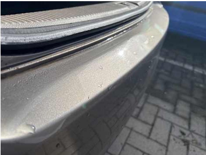
Stoßstange hinten (Lackschaden, Riss/Bruch, Verformung)
