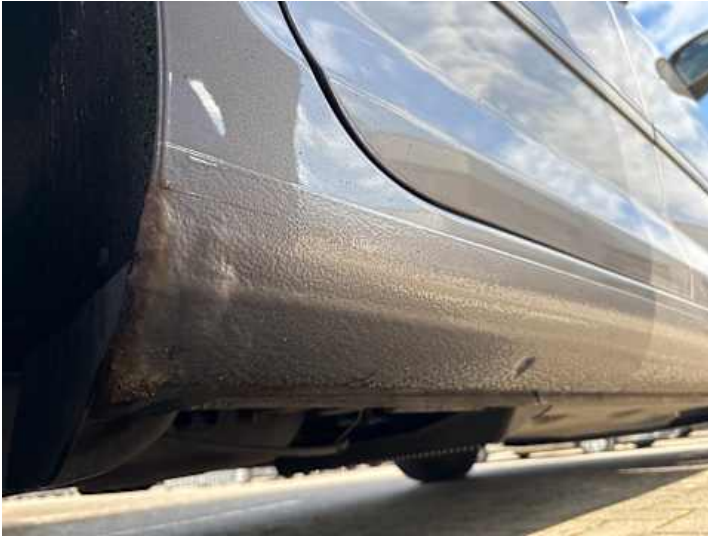
Schweller rechts (Rost, Lackschaden)
