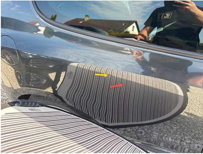
Seitenteil hinten rechts (Delle, Kratzer)
