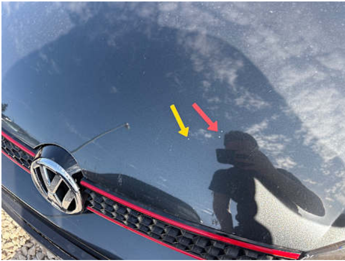
Motorhaube (Steinschlag, Rost)
