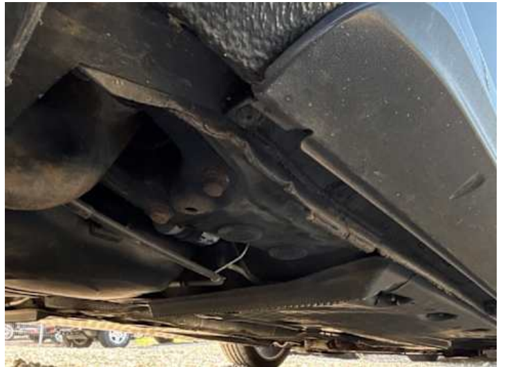
Schweller rechts (Verformung, Rost)
