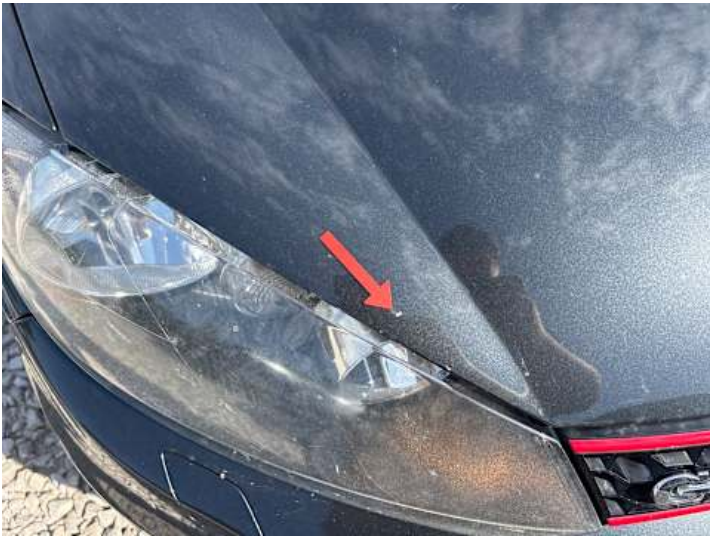
Motorhaube (Steinschlag, Rost)
