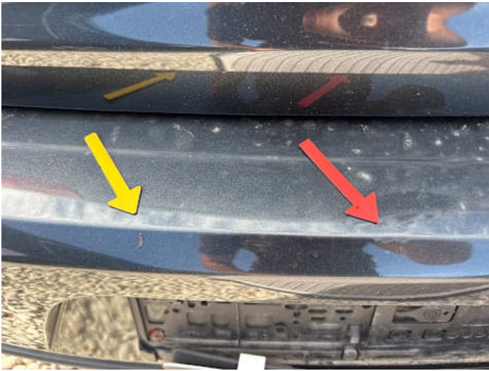
Stoßstange hinten (Kratzer, Lackschaden)
