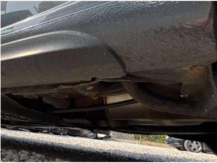
Schweller links (Verformung, Rost)
