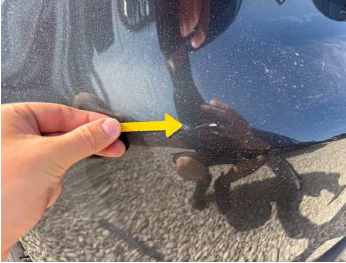
Stoßstange hinten (Kratzer, Lackschaden)
