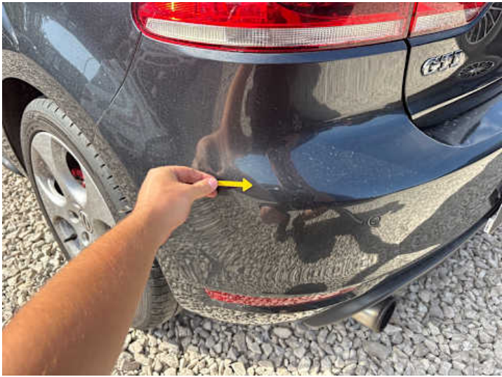
Stoßstange hinten (Kratzer, Lackschaden)
