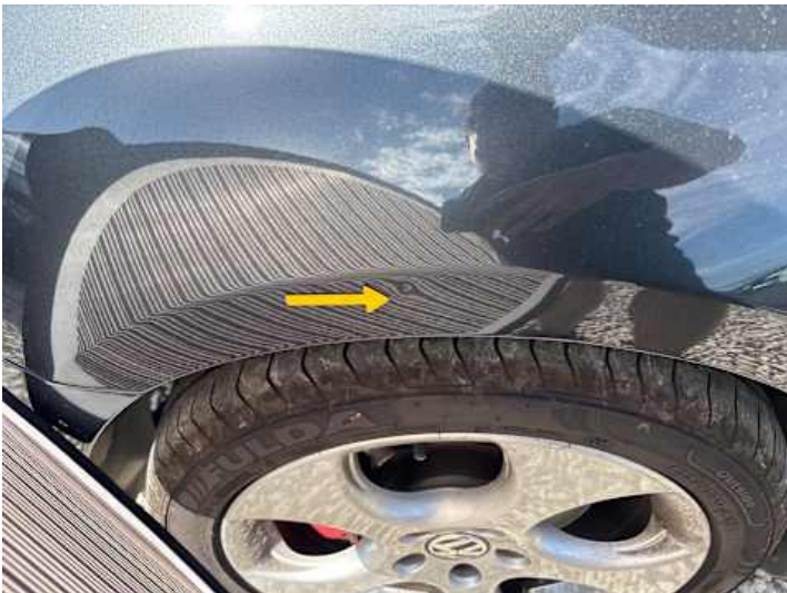
Kotflügel vorne links (Kratzer, Delle)
