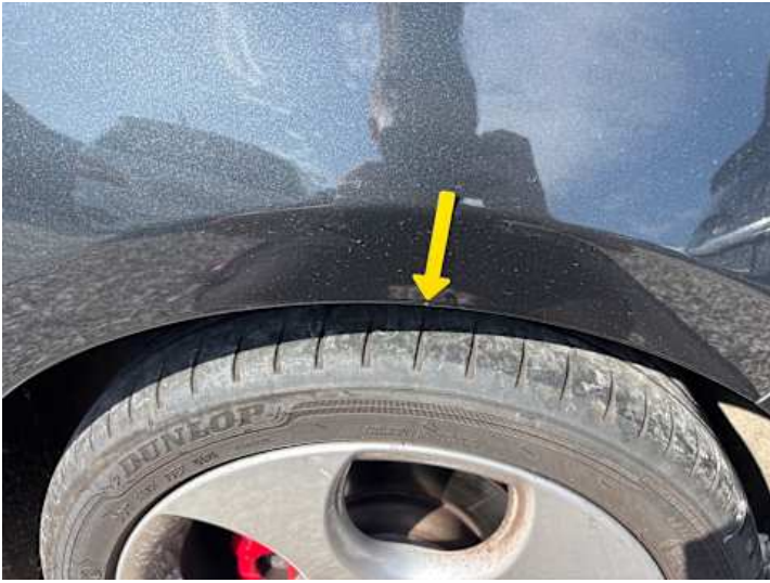
Seitenteil hinten links (Lackschaden, Rost)
