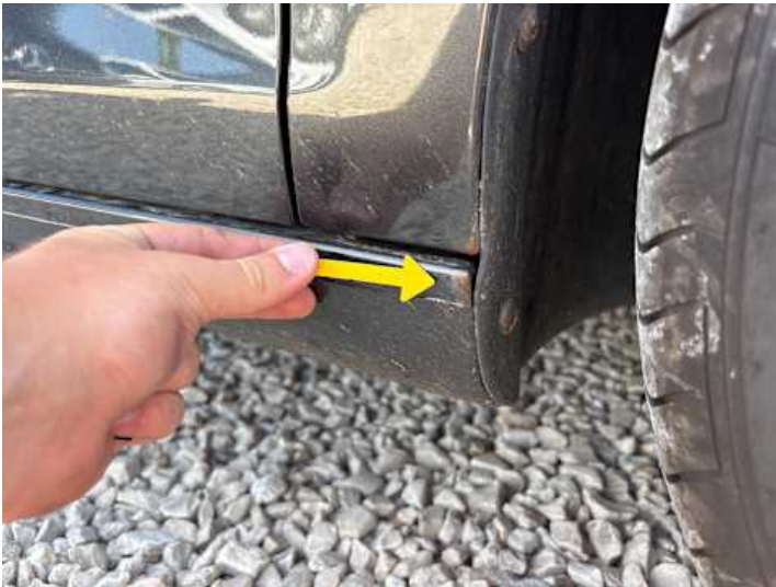
Schweller rechts (Lackschaden, Rost)
