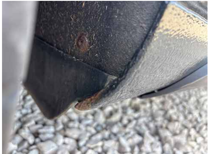
Schweller rechts (Lackschaden, Rost)
