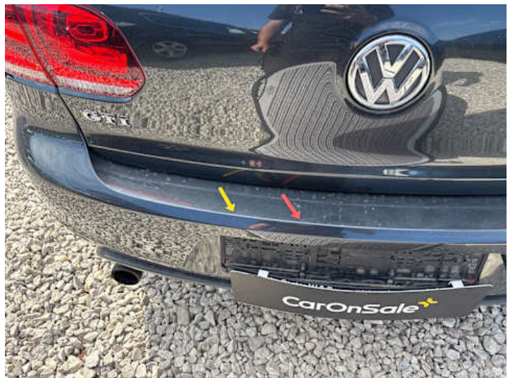
Stoßstange hinten (Kratzer, Lackschaden)
