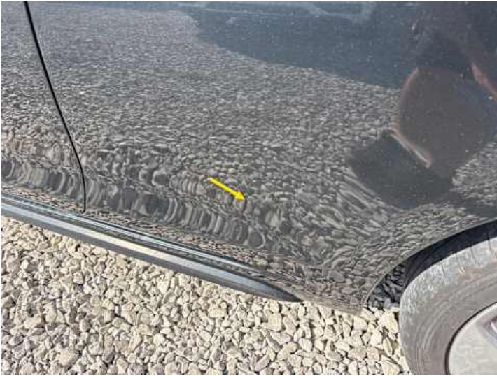
Seitenteil hinten links (Lackschaden, Rost)
