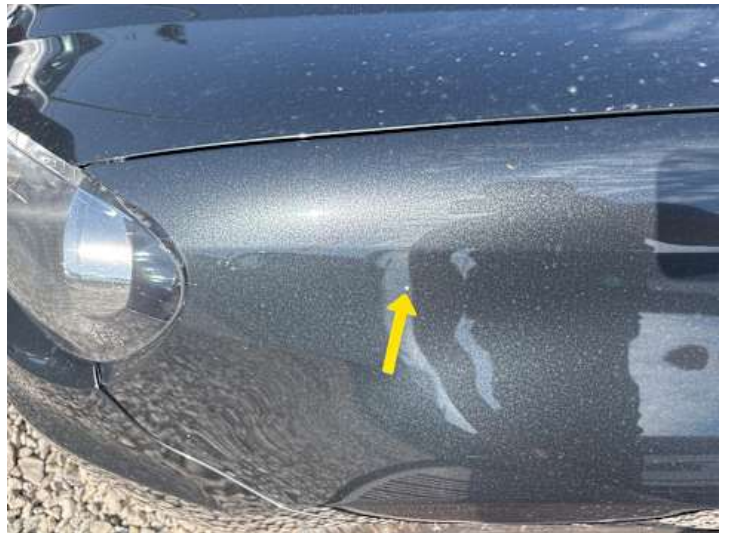
Kotflügel vorne links (Lackschaden)
