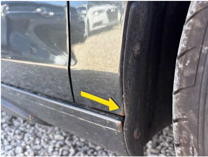
Kotflügel vorne rechts (Lackschaden, Rost)
