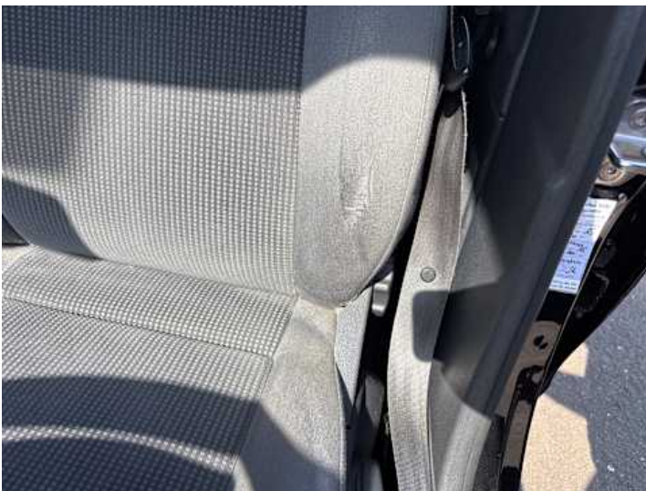
Innenraum (Verschleiß, Riss/Bruch)
