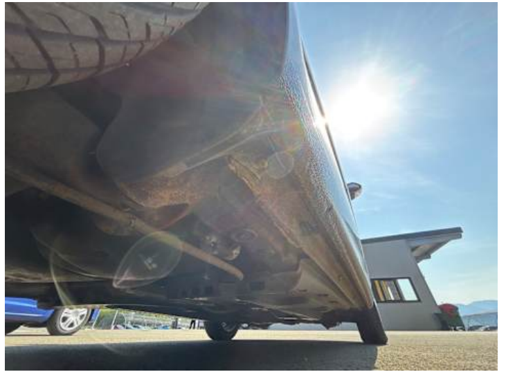
Schweller rechts (Unsachgemäß instand gesetzt, Rost)
