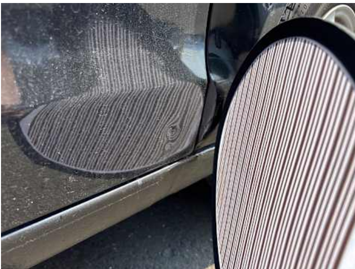
Beifahrertür (Delle, Unsachgemäß instand gesetzt, Rost)
