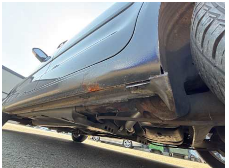
Schweller links (Unsachgemäß instand gesetzt, Rost)
