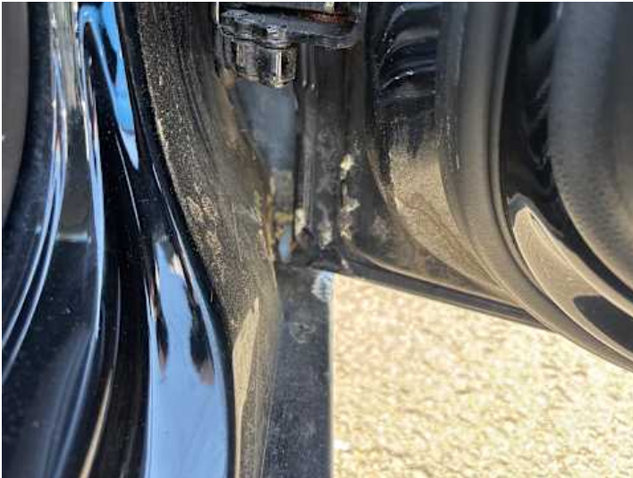
Beifahrertür (Delle, Unsachgemäß instand gesetzt, Rost)
