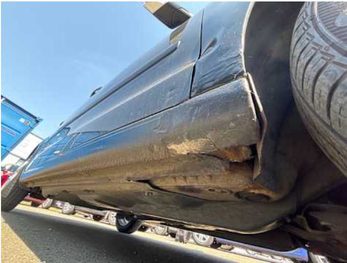
Schweller rechts (Unsachgemäß instand gesetzt, Rost)
