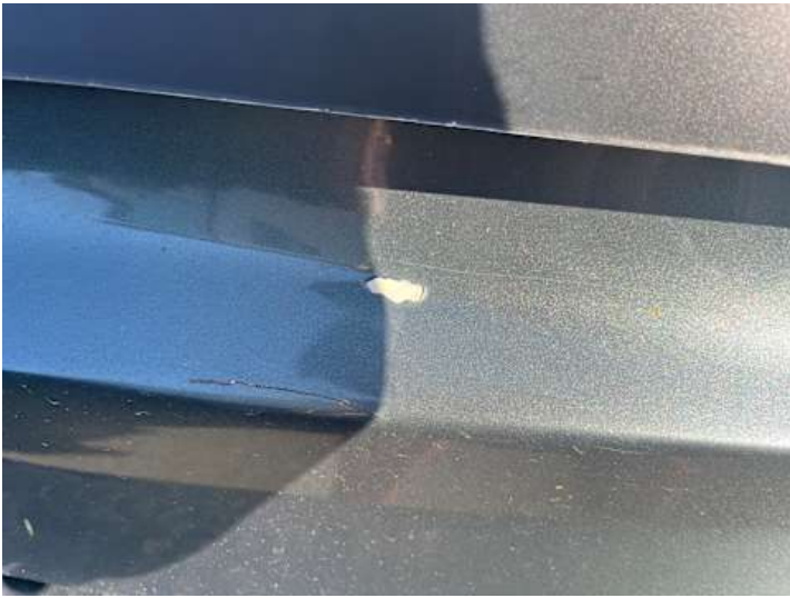
Heckklappe (Lackschaden, Kratzer)
