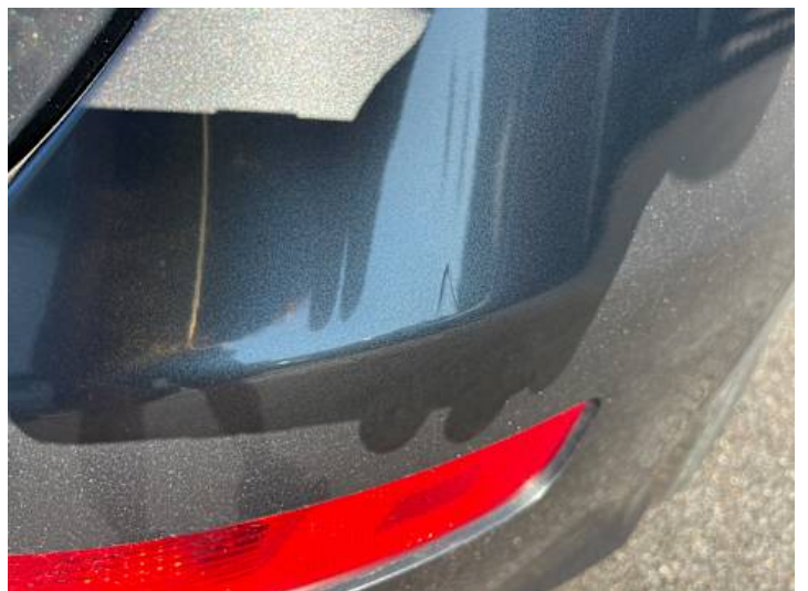
Stoßstange hinten (Lackschaden, Kratzer)
