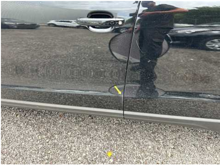
Fahrertür (Lackschaden, Rost)
