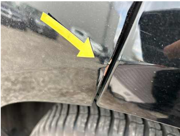
Türe hinten links (Lackschaden)
