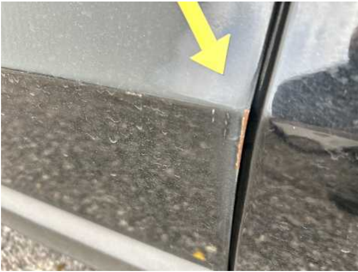
Fahrertür (Lackschaden, Rost)
