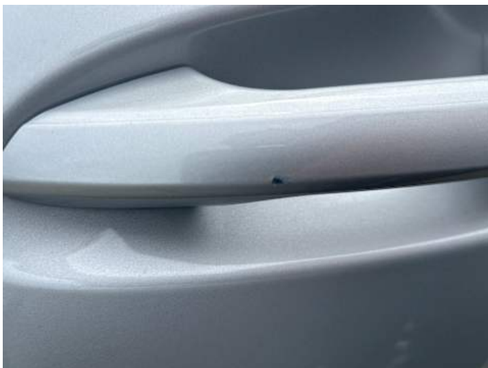
Türe hinten links (Lackschaden)
