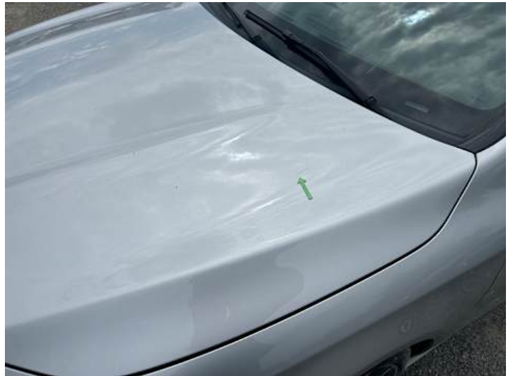
Motorhaube (Lackschaden, Kratzer)
