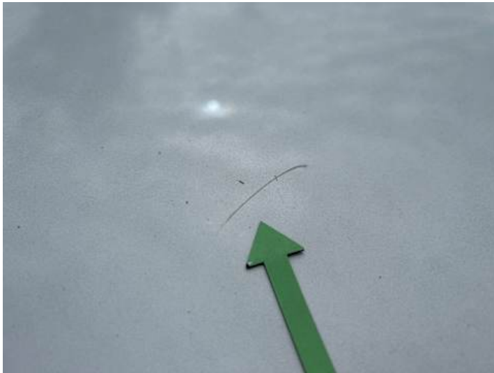
Motorhaube (Lackschaden, Kratzer)
