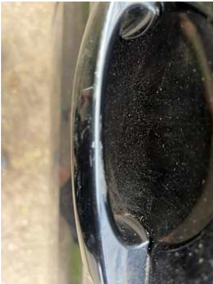
Seitenteil hinten links (Lackschaden)
