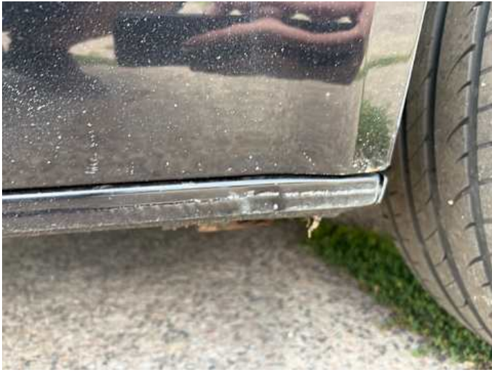
Schweller rechts (Steinschlag)
