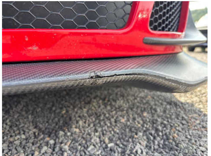
Stoßstange vorne (Riss/Bruch, Kratzer)
