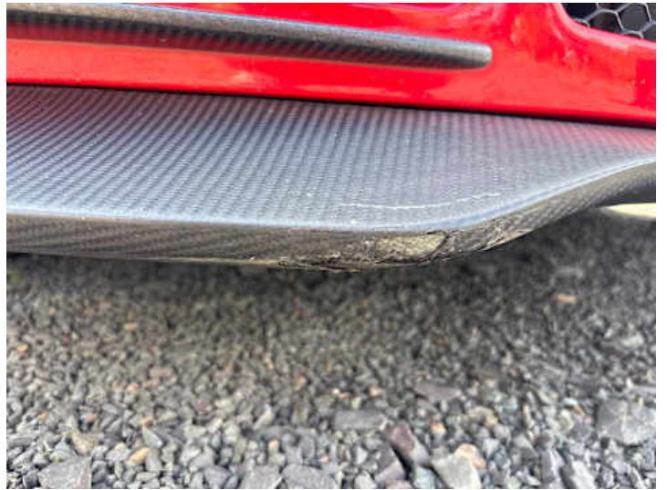
Stoßstange vorne (Riss/Bruch, Kratzer)
