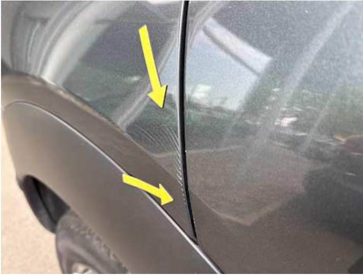
Seitenteil hinten rechts (Kratzer, Lackschaden)
