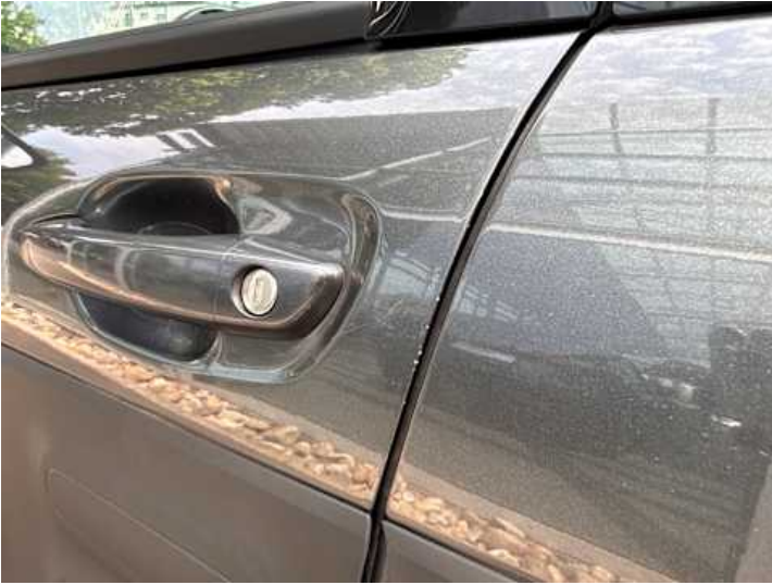
Fahrrertür (Lackschaden, Kratzer)
