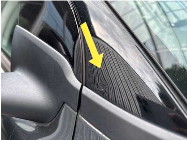
Dach (Delle, Lackschaden)
